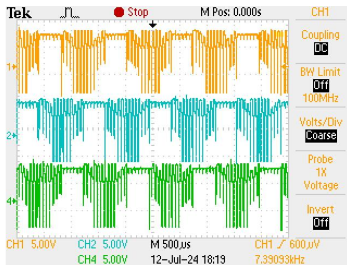
Slika 5.10 Valni oblici napona faza pri 1.7A, 7030 okr/min
