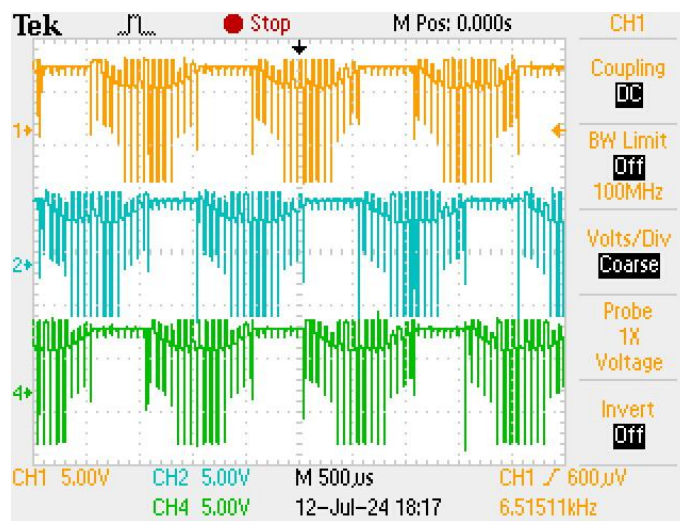
Slika 5.9 Valni oblici napona faza pri 1.1A, 5670 okr/min
