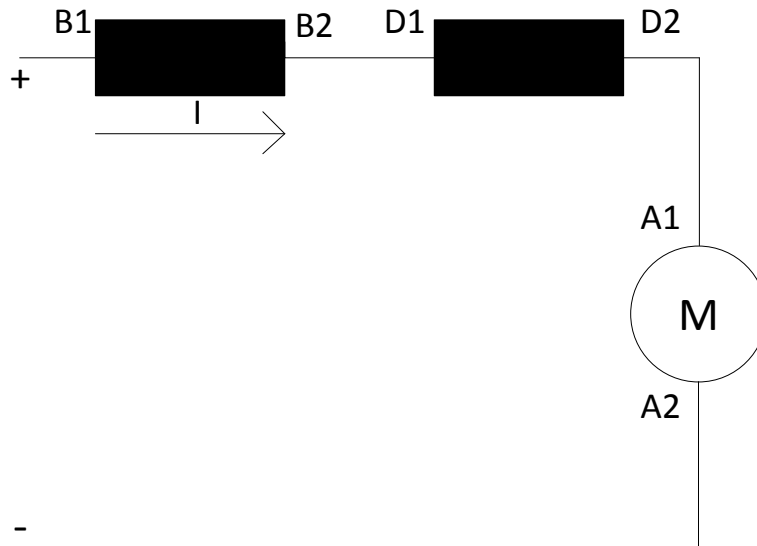
Slika 2.6 Shema istosmjernog motora sa serijskom uzbuđom
