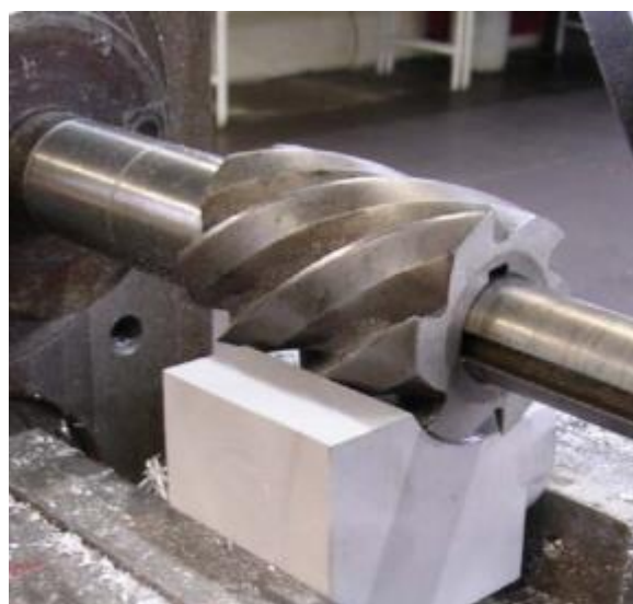
Slika 4. Prikaz protusmjernog glodanja [3]
