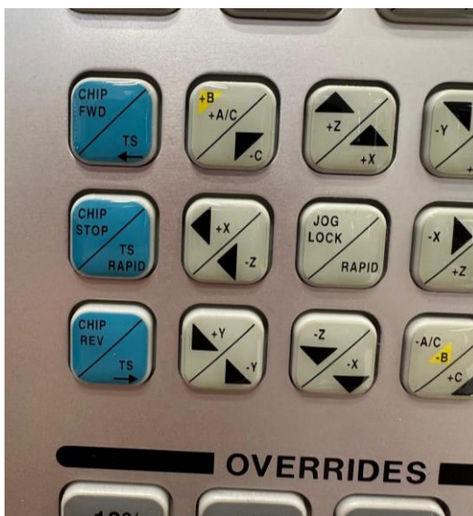
Slika 44. Tipke za pomicanje alata u određenom smjeru
