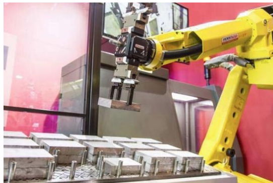
Slika 14. Izmjena obratka pomoću robota [12]
