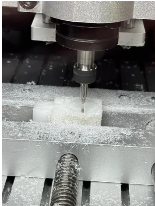
Slika 75. Prikaz obratka tijekom izrade džepa
