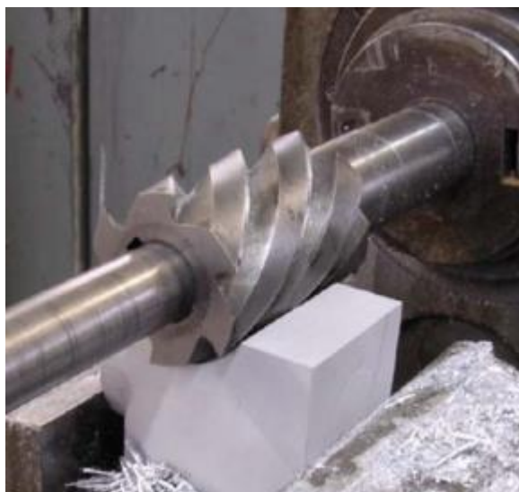
Slika 3. Prikaz istosmjernog glodanja [3]
