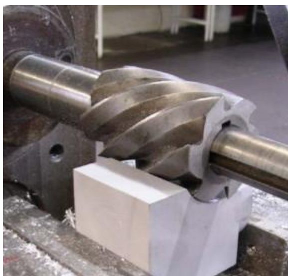
Slika 4. Prikaz protusmjernog glodanja [3]
