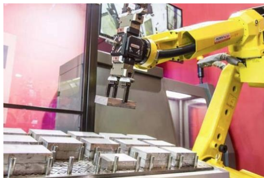
Slika 14. Izmjena obratka pomoću robota [12]
