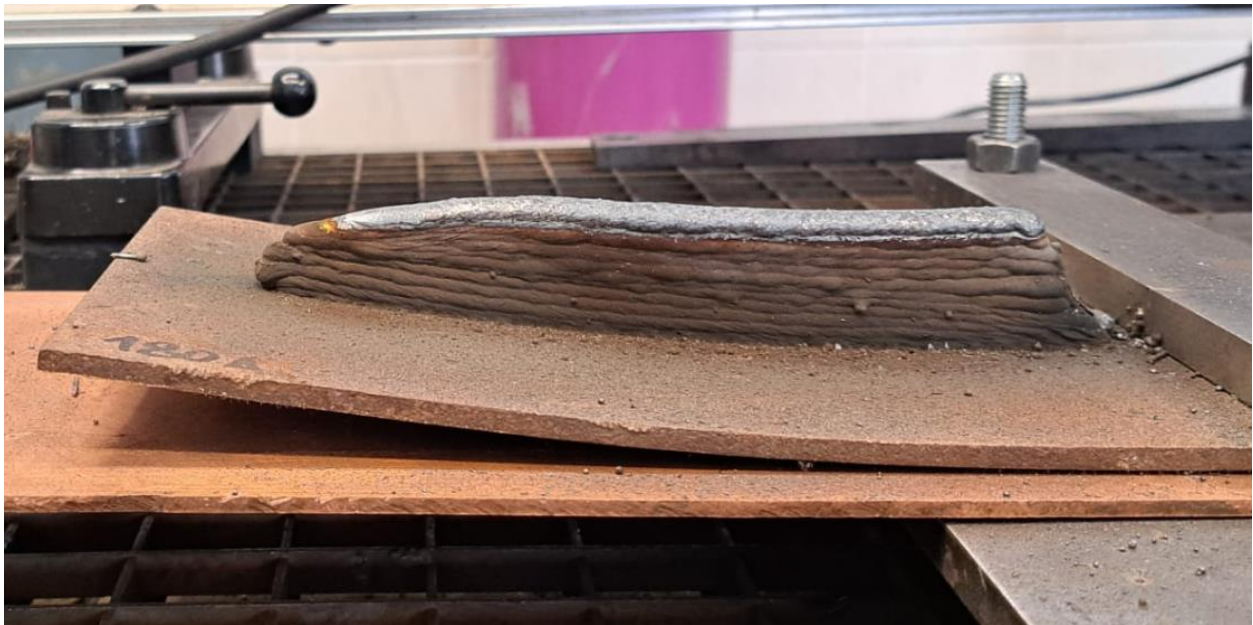
Slika 35 Zid navaren strujom jakosti 180 A
