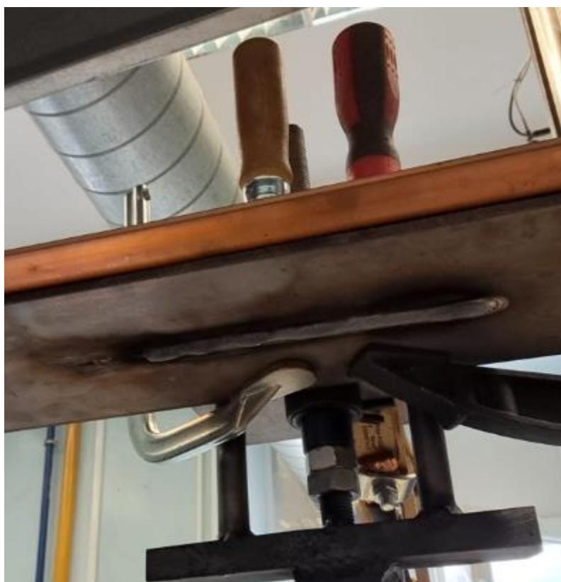
Slika 39 Druga perspektiva prvog sloja navara u PE položaju ( I=180\text{ A} ; v=36\text{cm/min} ; z=4,5\text{ mm} )
