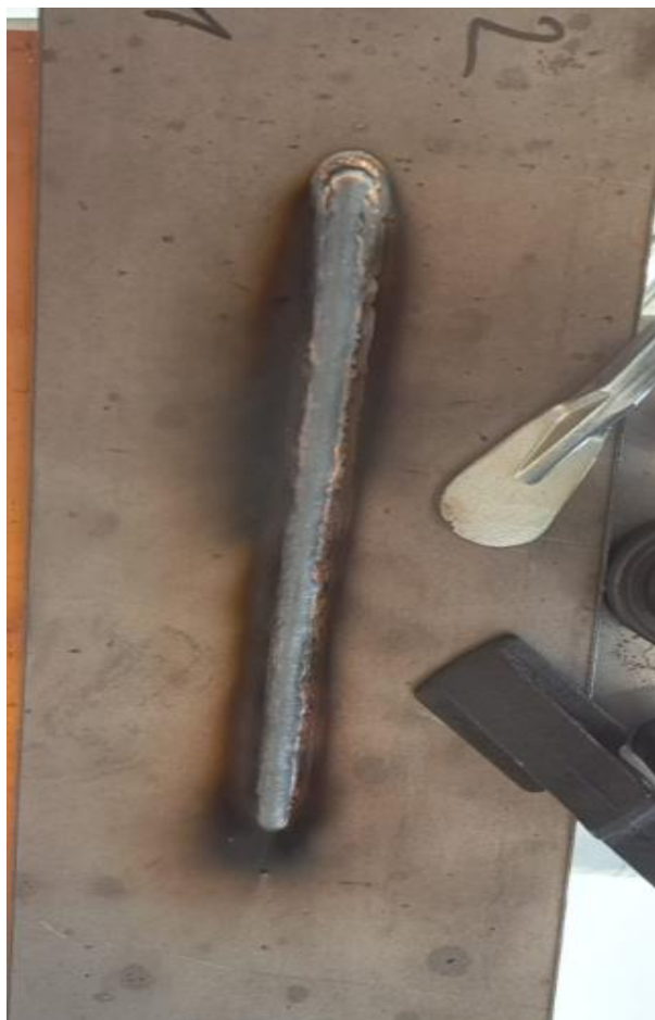
Slika 41 Prvi sloj navara u PE položaju ( I=180\text{ A} ; v=36\text{cm/min} ; z=4,5\text{ mm} )
