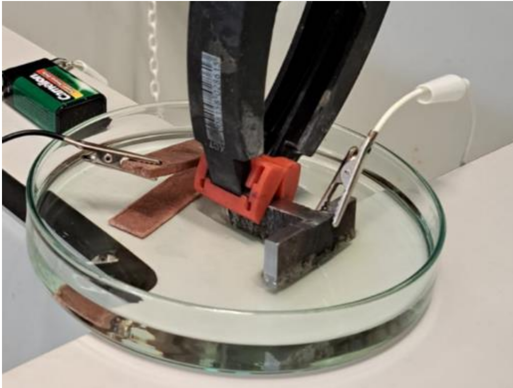
Slika 51 Elektrokemijska reakcija površine uzorka u solnoj kiselini
