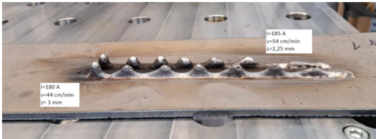
Slika 43 Drugi sloj navara u PE položaju
