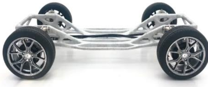
Slika 15 Šasija električnog automobila izrađena WAAM-om [22]
