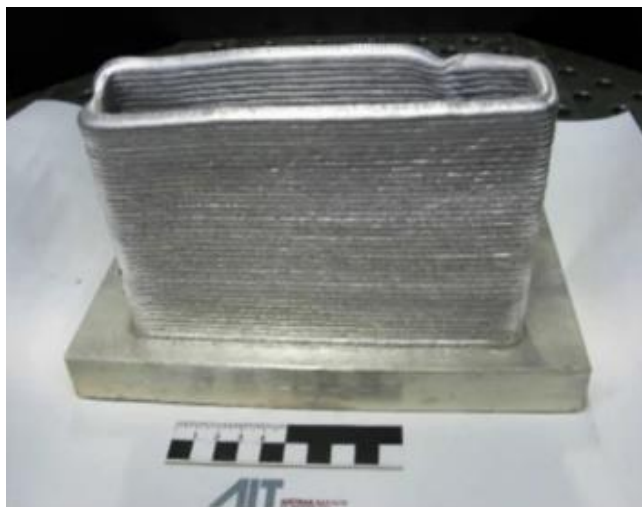
Slika 12 Uzorak magnezijeve legure izradene WAAM-om [16]
