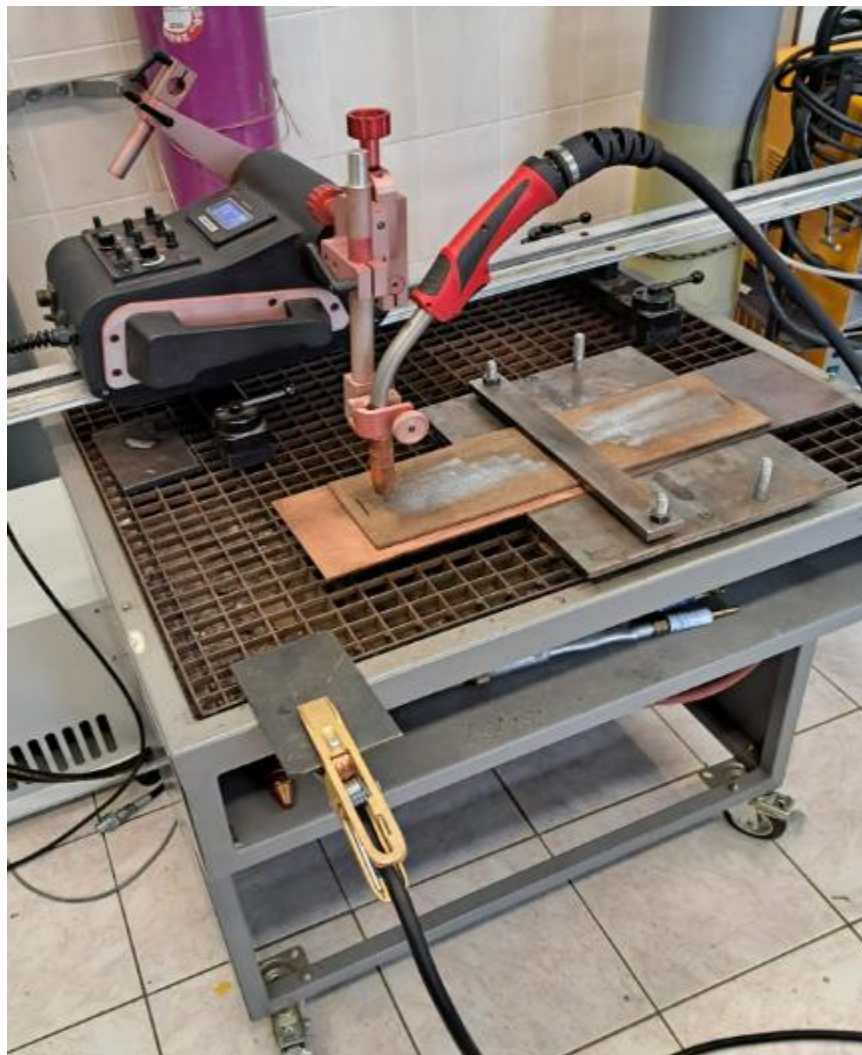
Slika 31 Pištolj za zavarivanje postavljen u početnoj točki
