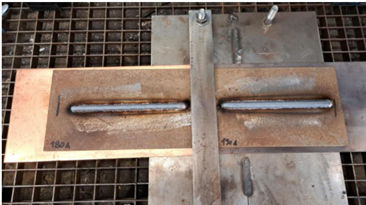
Slika 33 Prvi sloj navara u PA položaju
