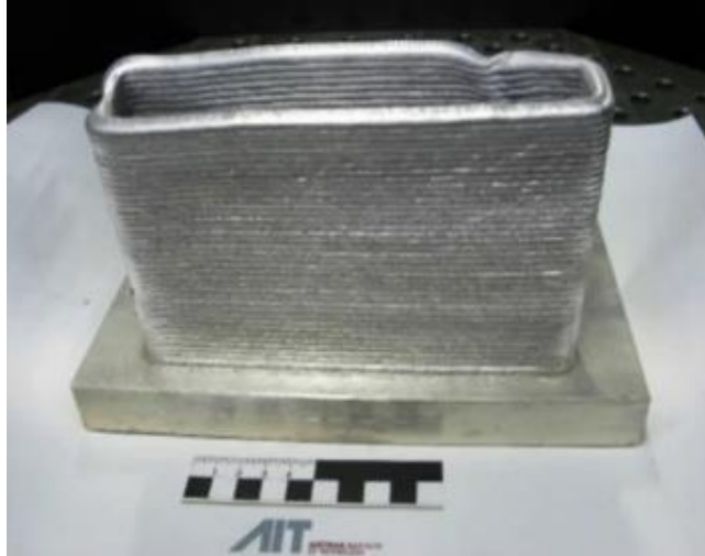
Slika 12 Uzorak magnezijeve legure izradene WAAM-om [16]
