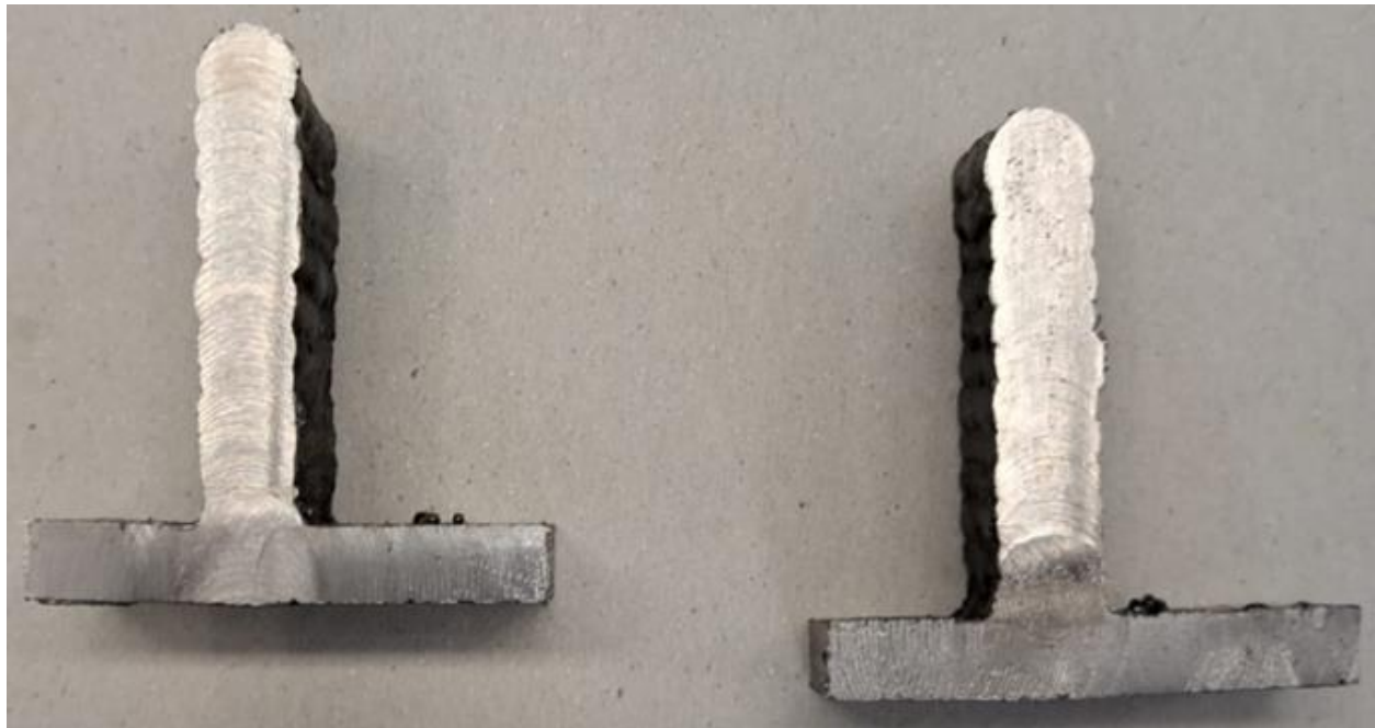
Slika 48 Površina uzorka nakon obrade glodanja navarenog strujom jakosti 180 A (lijevo) i 190 A (desno)
