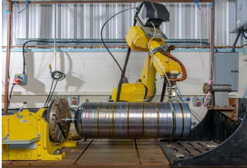
Slika 17 Izrada tlačne posude WAAM postupkom [25]
