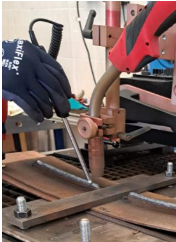
Slika 32 Mjerenje međuprolazne temperature
