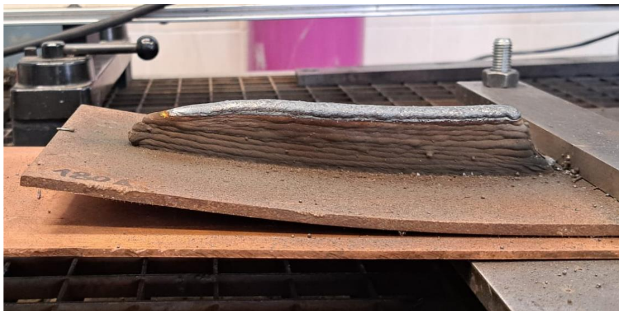
Slika 35 Zid navaren strujom jakosti 180 A
