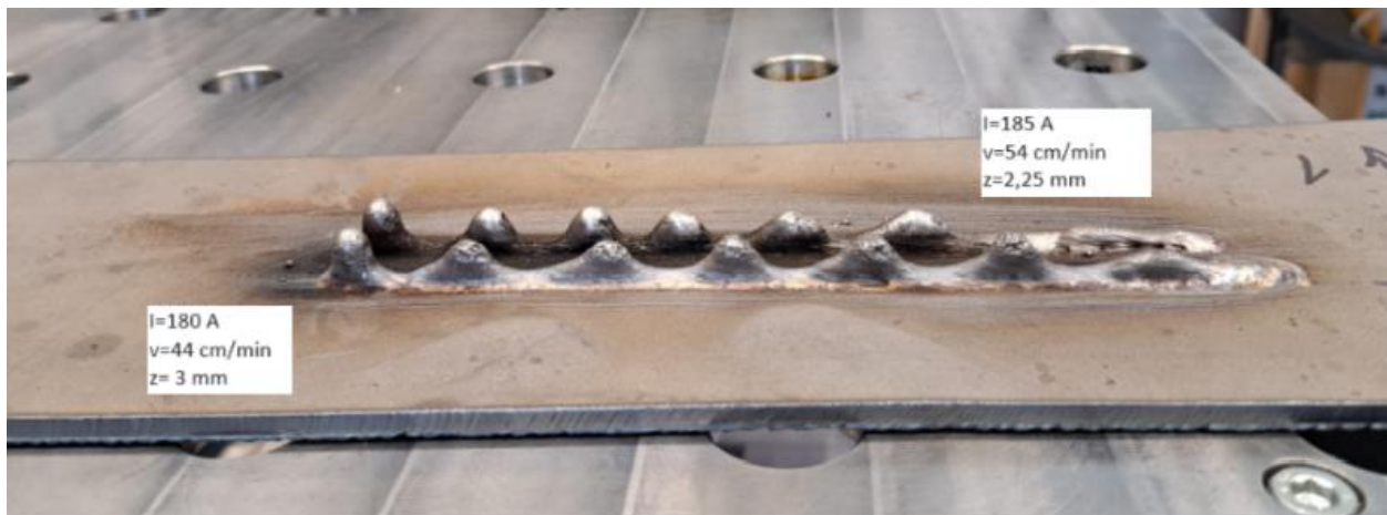
Slika 43 Drugi sloj navara u PE položaju
