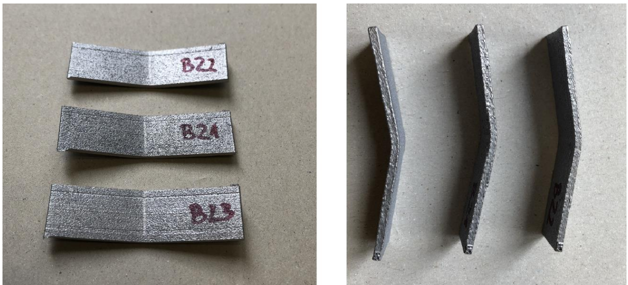
Slika 6.41 Uzorci nakon savijanja
