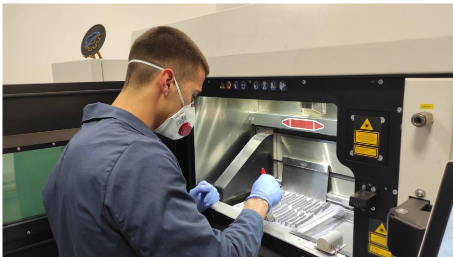
Slika 6.16 Odstranjivanje viška praša nakon printanja
