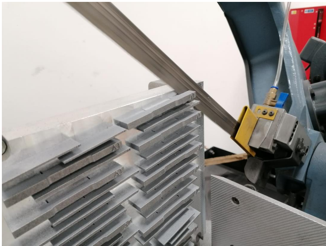
Slika 6.20 Odvajanje uzoraka s ploče
