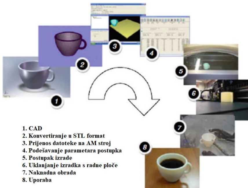
Slika 2.3 Koraci aditivne proizvodnje [1]
