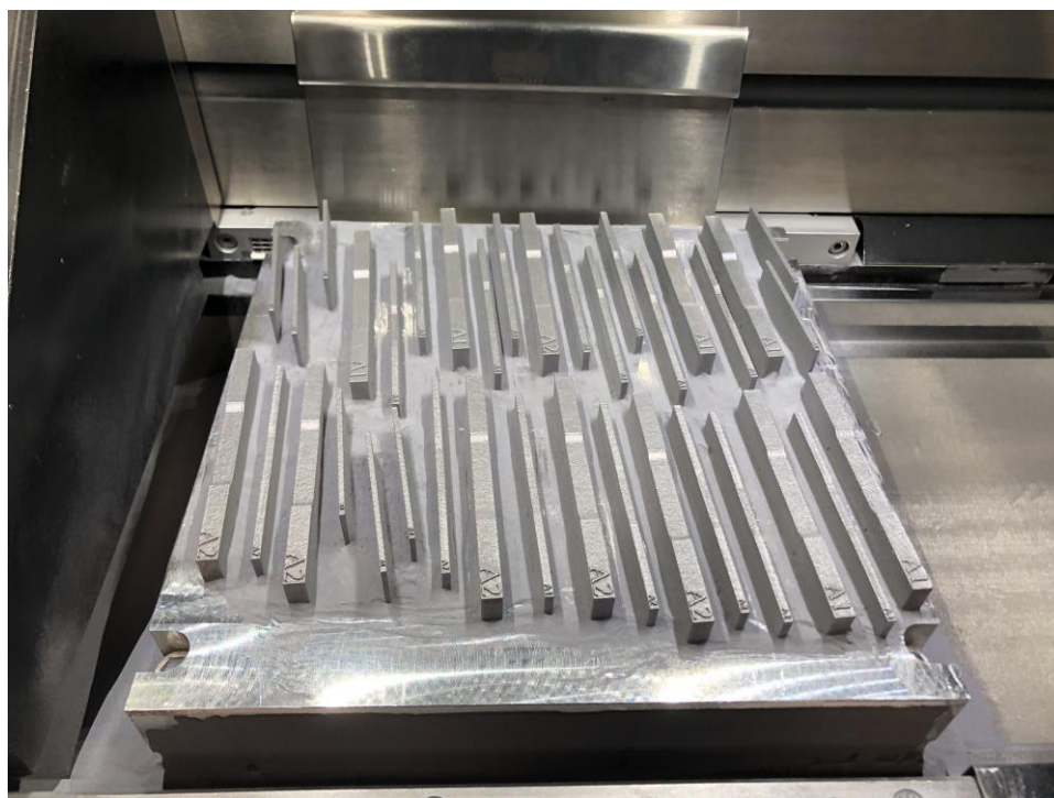
Slika 6.17 Ploča s isprintanim ispitnim uzorcima
