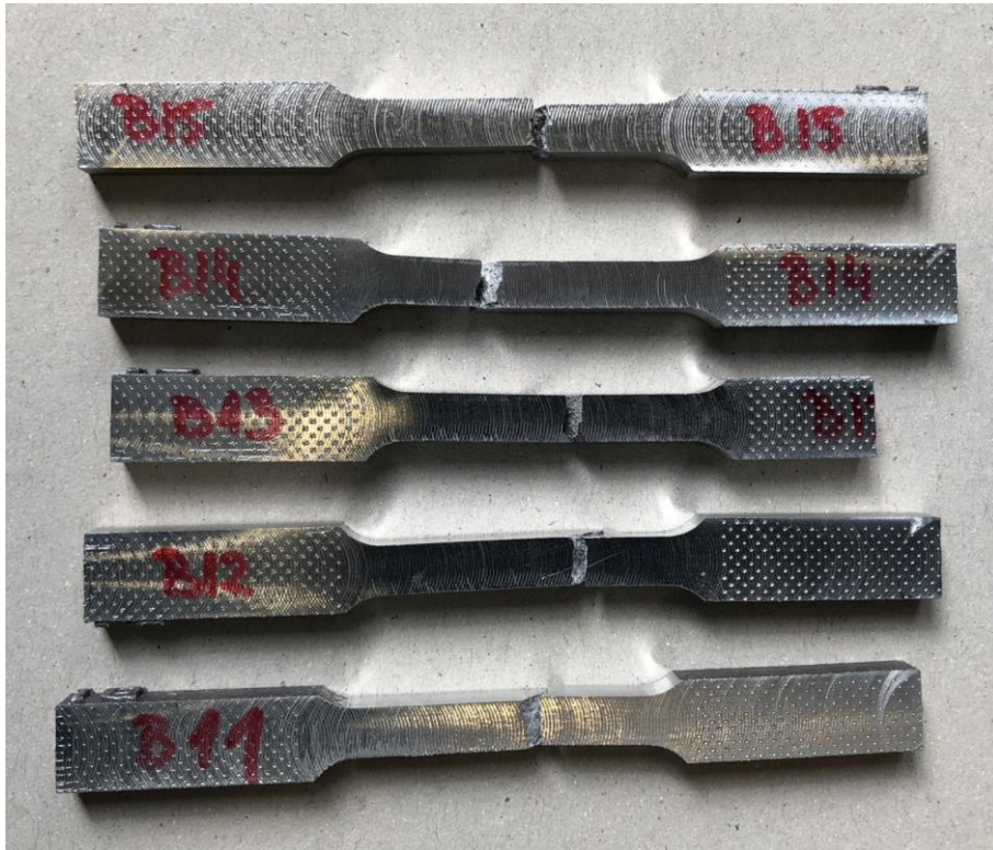
Slika 6.26 B1 epruvete nakon ispitivanja
