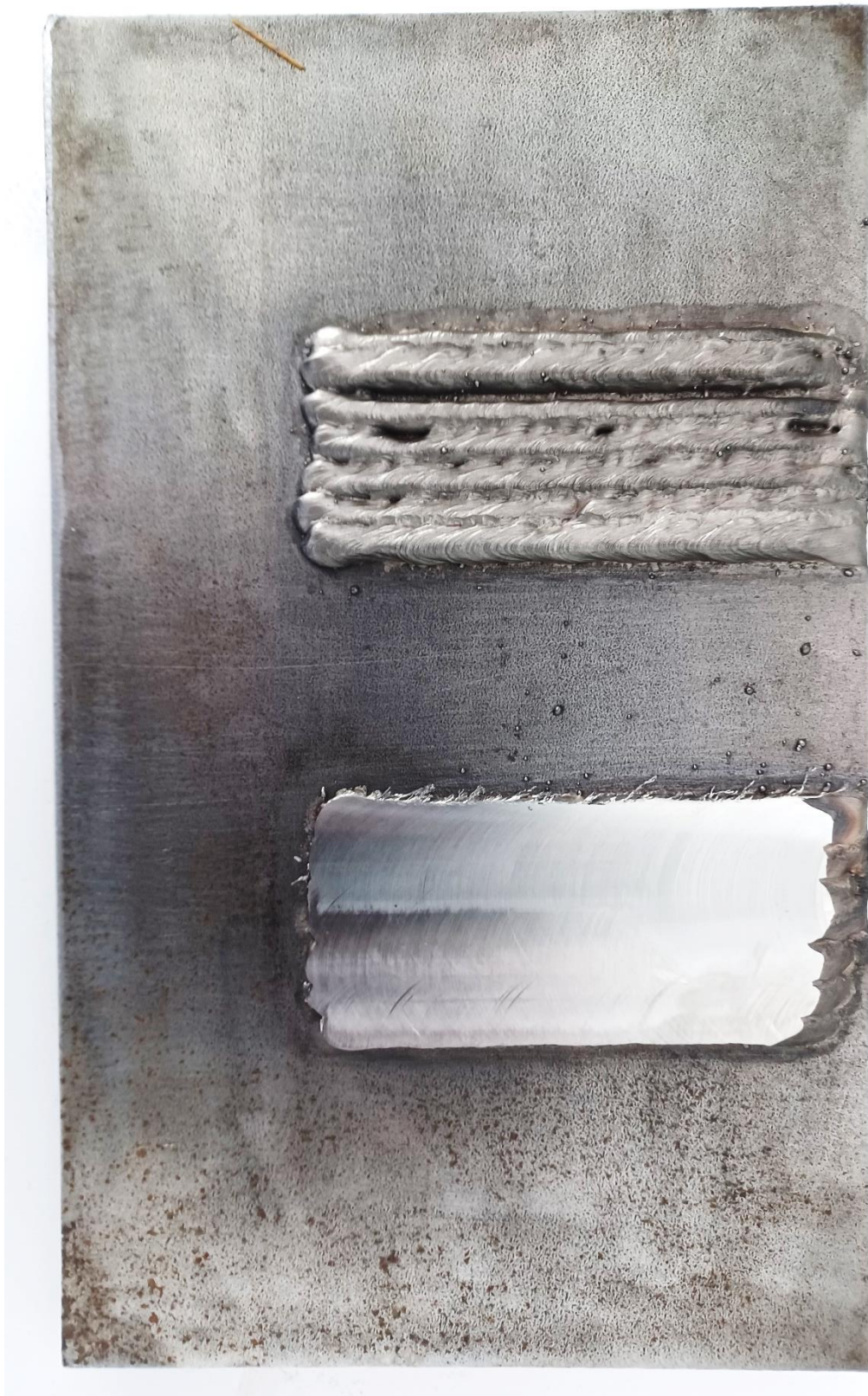
Slika 51 – OM s obrađenim navarenim slojem nehrđajućeg čelika prije izrezivanja uzoraka na strojnoj tračnoj pili
