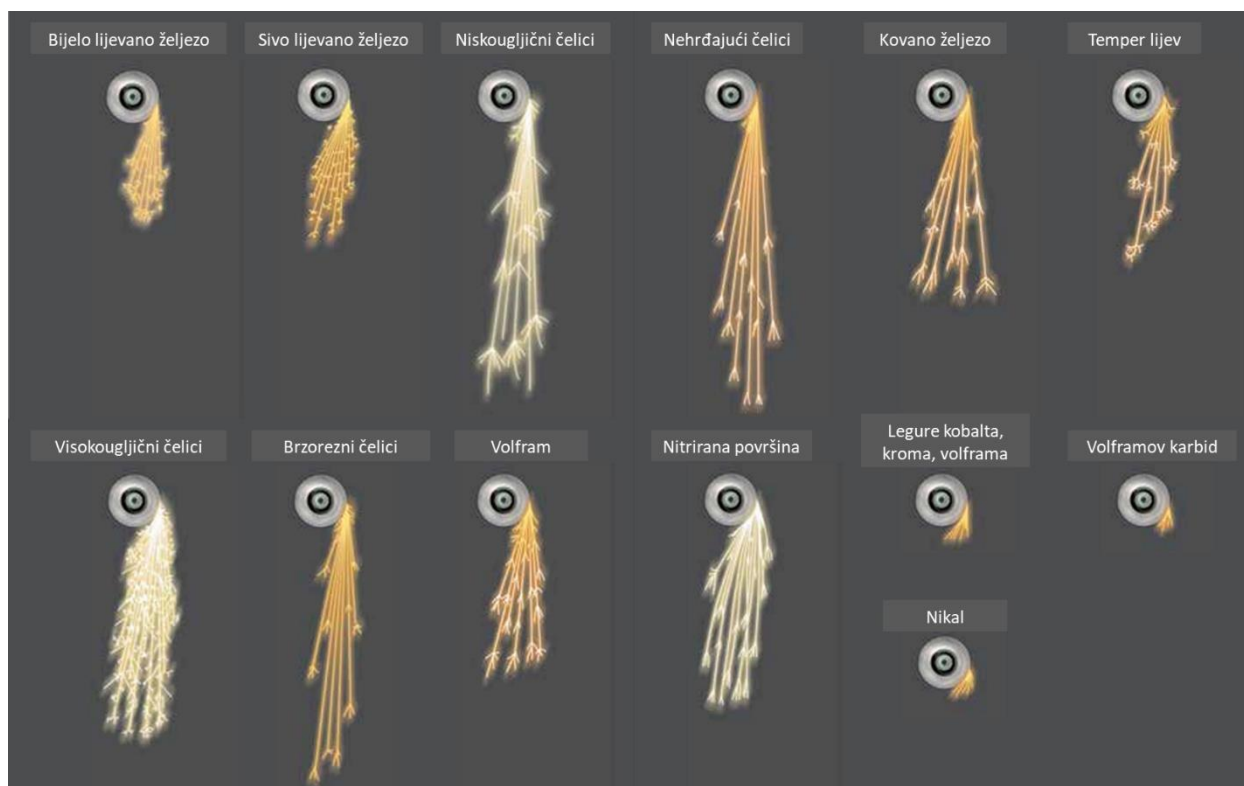
Slika 20 – Test iskrenja odabranih osnovnih materijala [5]
