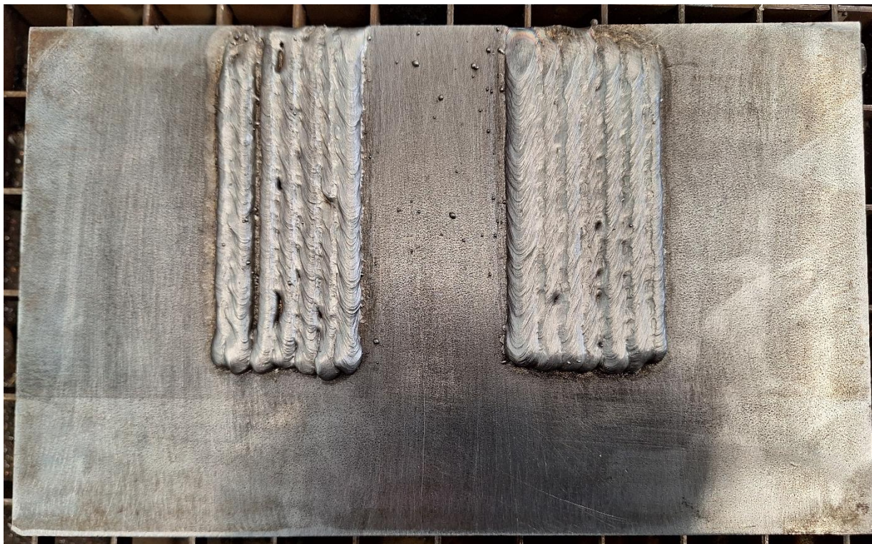
Slika 48 – Ohlađeni navareni sloj dobiven s jakosti struje navarivanja 170 A (lijevo) te sloj dobiven s jakosti struje navarivanja 190 A (desno)
