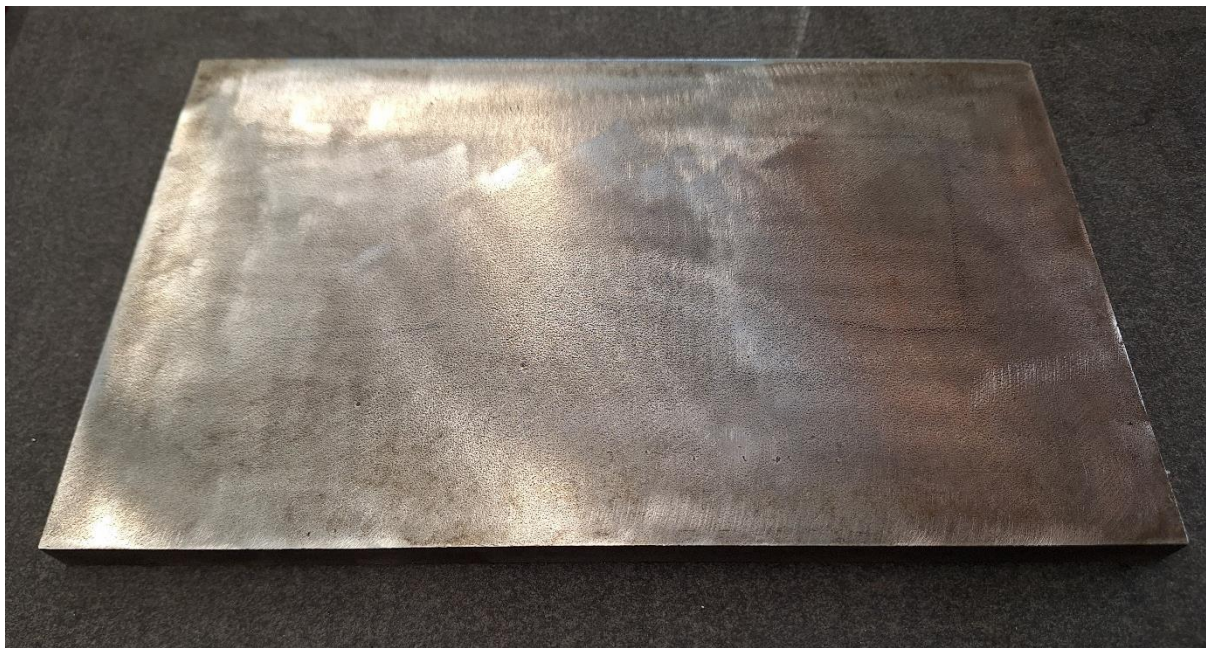
Slika 39 – Ploča od općeg konstrukcijskog čelika S235JR obrađena kutnom brusilicom
