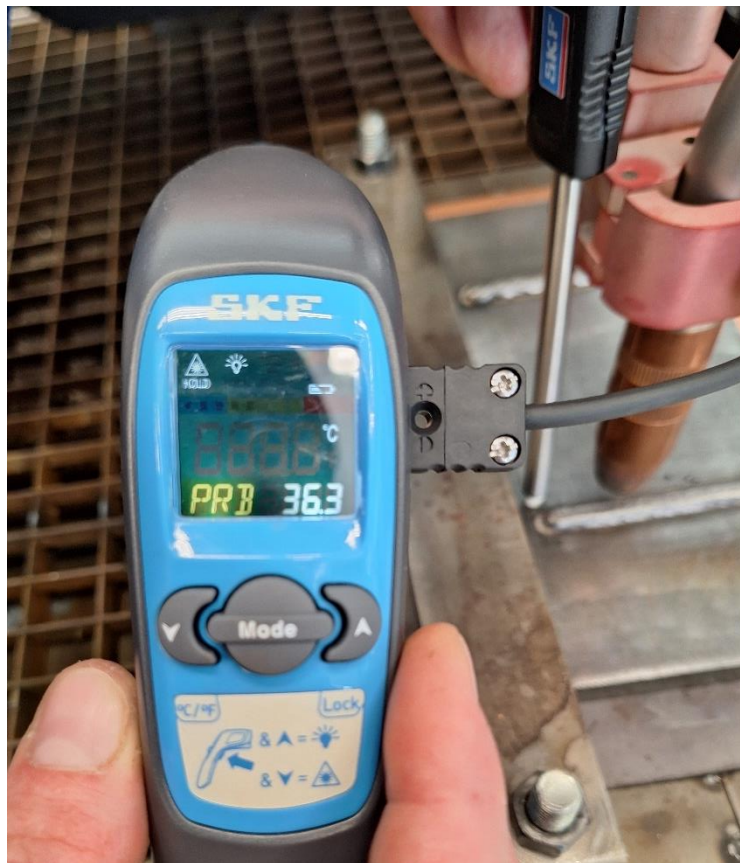
Slika 46 – Mjerenje temperature prije trećeg prolaza
