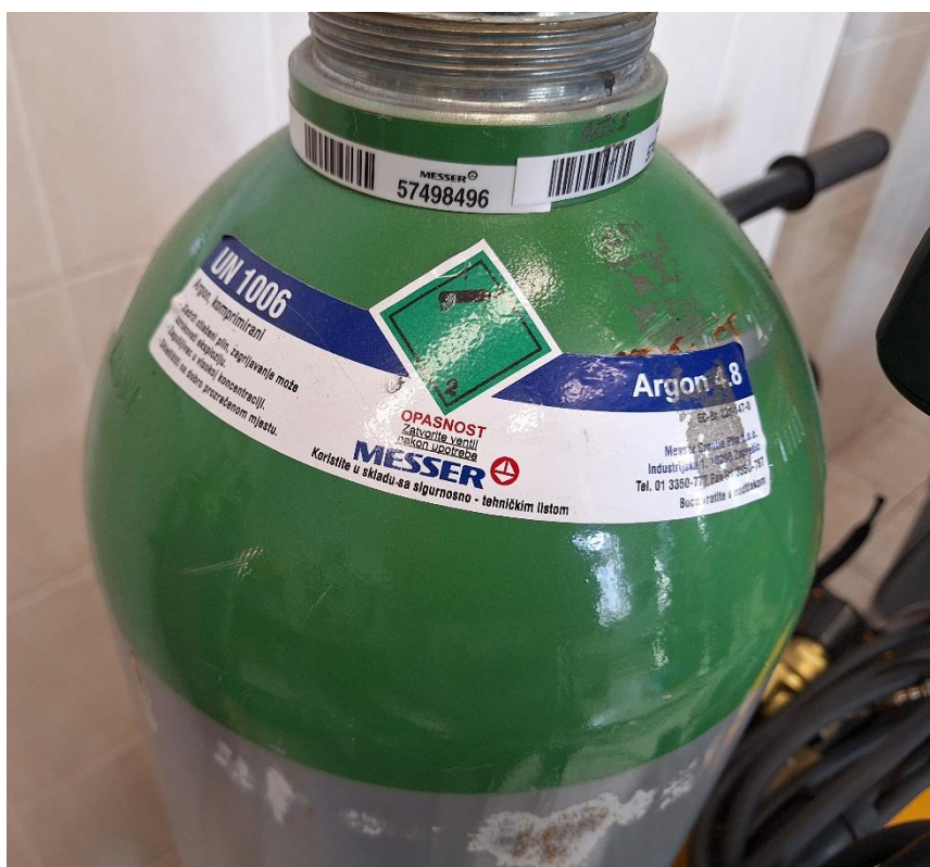
Slika 40 – Oznaka na plinskoj boci Argona 4.8 korištenog u postupku navarivanja
