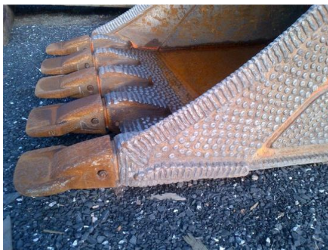
Slika 16 – Prolazi deponirani u određenim intervalima i točkasti navari navareni na žlicu za bager kao zaštita od trošenja [8]
