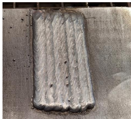
Slika 15 – Usporedni prolazi s kontinuiranim preklapanjem
