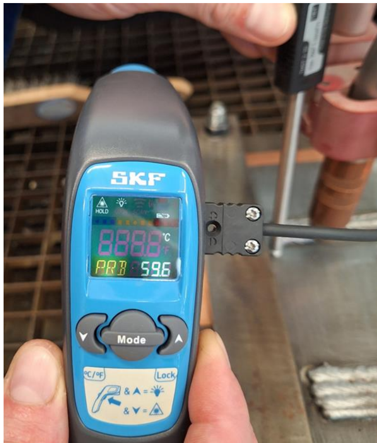
Slika 47 – Mjerenje temperature prije osmog prolaza
