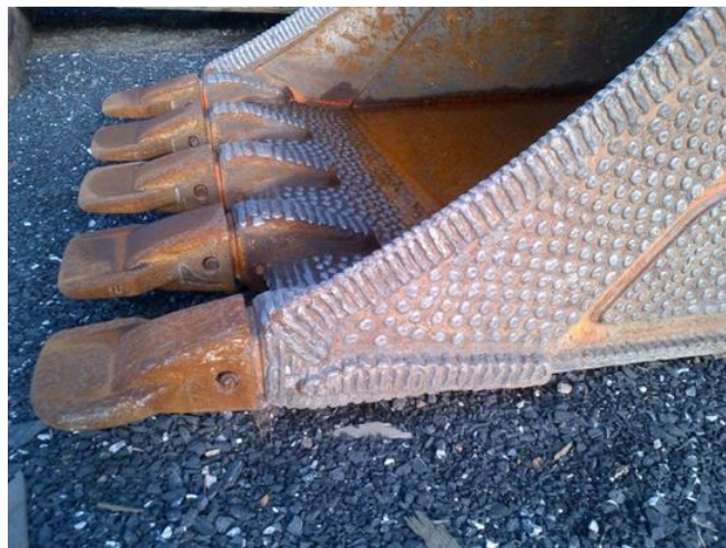
Slika 16 – Prolazi deponirani u određenim intervalima i točkasti navari navareni na žlicu za bager kao zaštita od trošenja [8]
