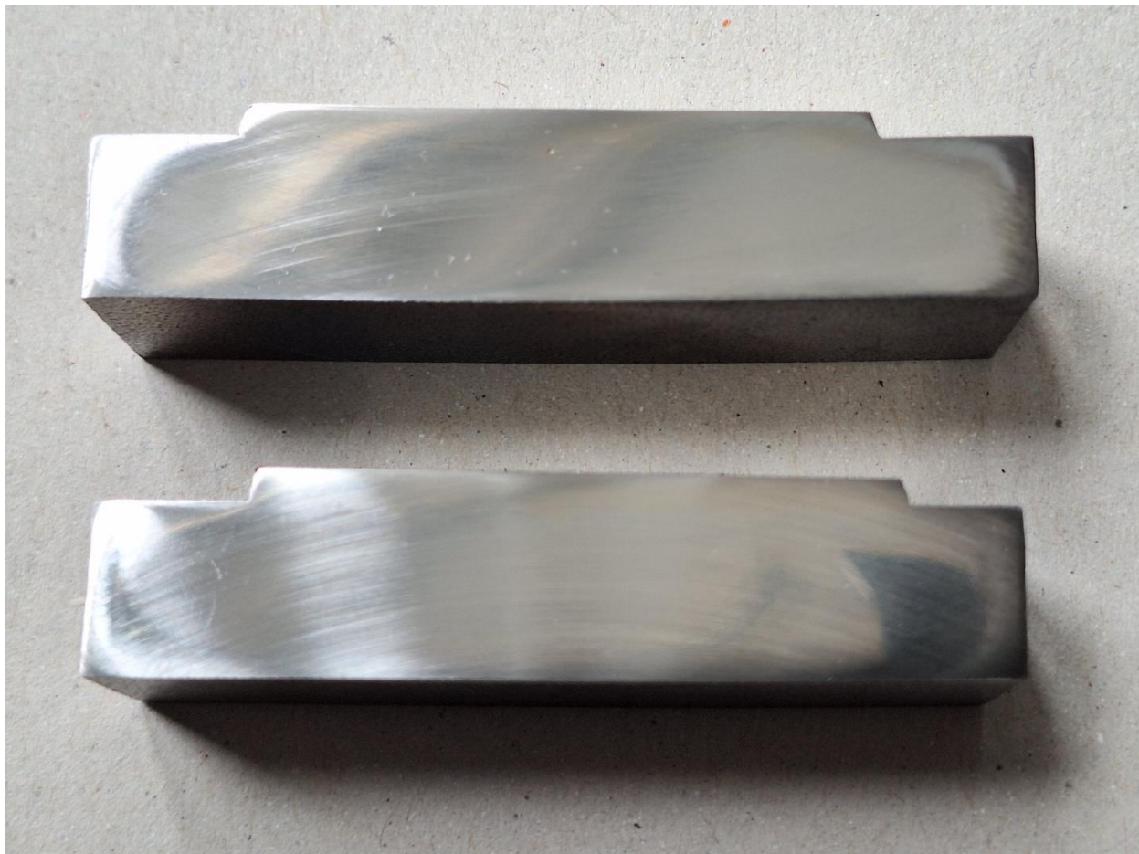
Slika 52 – Uzorci iz sloja navarenog s jakosti struje navarivanja 190 A nakon završetka brušenja
