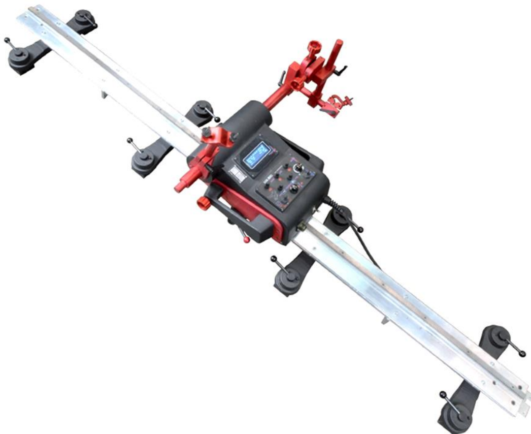
Slika 33 – Automat za precizno vođenje pištolja Promotech Rail Bull [31]
