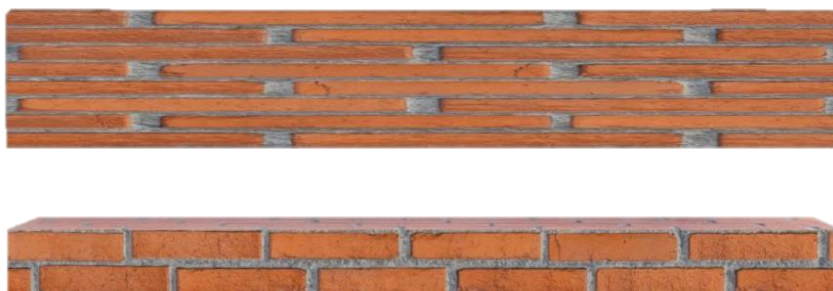
Slika 27 – Primjer „stretching“ tekture
