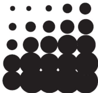
Slika 10. Različiti postotci RTV kod AM rastera
