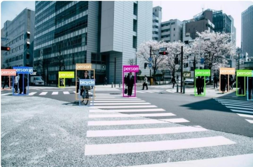
Slika 4-5 Primjer korištenja YOLOv9 modela (Preuzeto 23.06.2024. s <https://viso.ai/computer-vision/yolov9/>)
