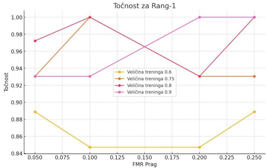
Slika 9-22 FaceNet - Rang-1 mjerjenje (Vlastita izrada 20.8.2024)
