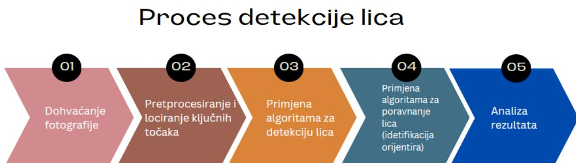
Slika 2-2 Dijagram toka detekcije lica (Vlastita izrada, 20.05.2024.)
