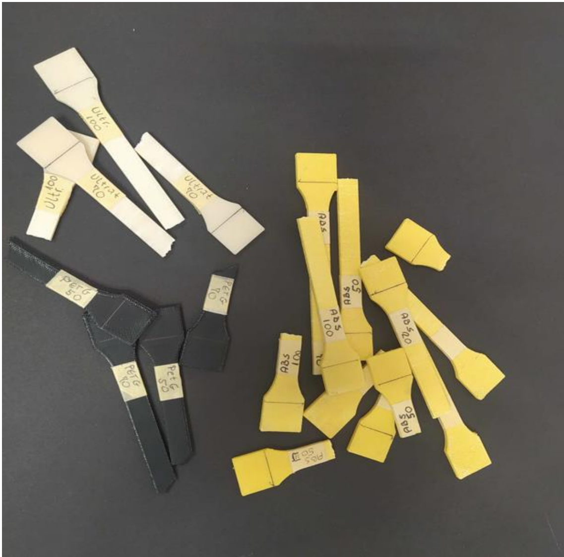
Slika 9.18. Epruvete nakon pokusa
