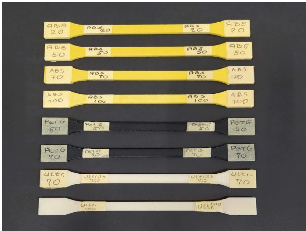
Slika 9.9. Ispitne epruvete za statičko vlačni pokus
