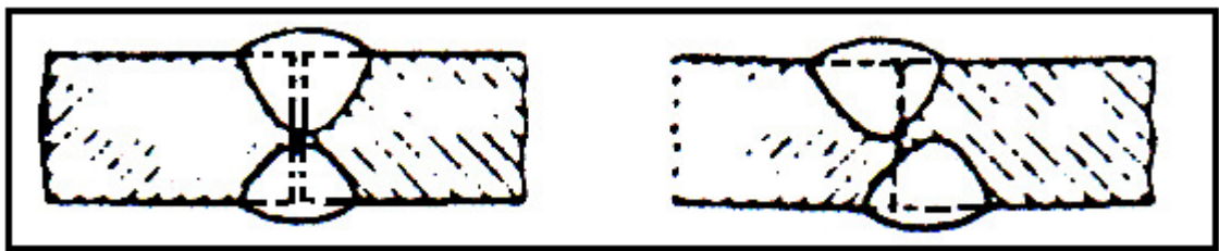
Slika 5.5 Izgled nprovarenog korijena zavara[7]
