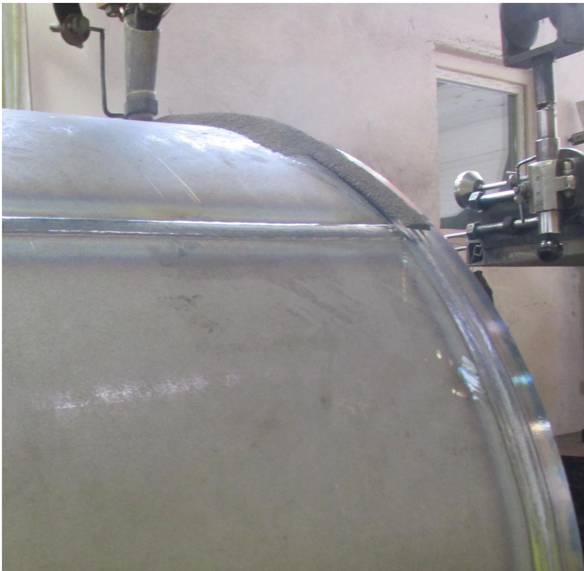
Slika 6.10 Odvajanje troske od zavarenog spoja[9]
