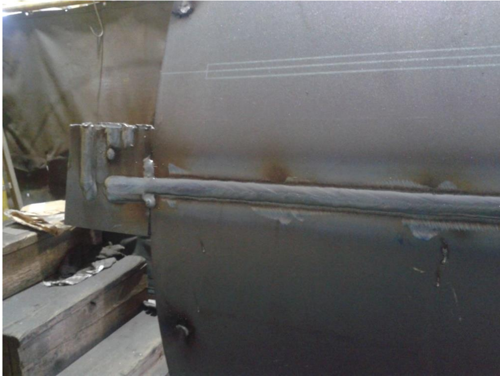
Slika 6.3 Zavarivanje plašta s vanjske strane[9]
