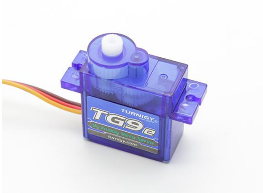
Slika 7. Servo motor TG9e [9]
