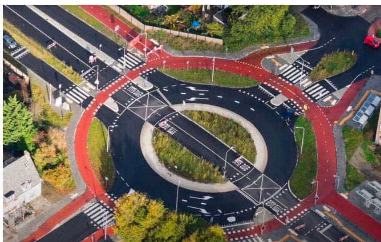
Slika 5 Turbo kružni tok u Nizozemskoj
