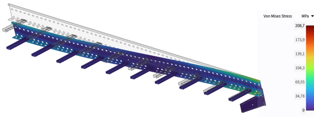
Slika 4.33 Ekvivalentna von Misesova naprezanja na optimiranom modelu
