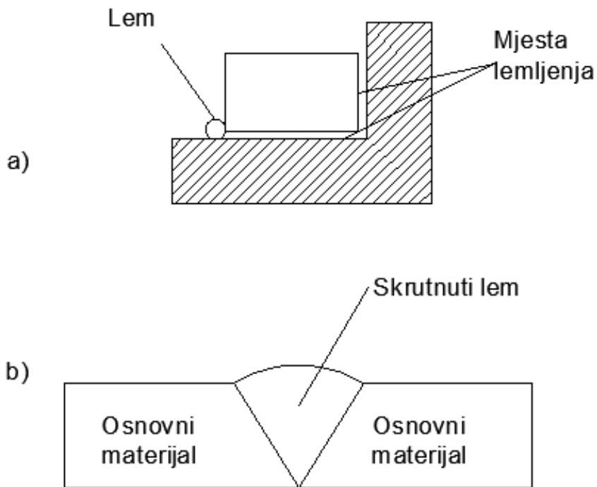
Slika 2.1. Shema kapilarnog lemljenja (a) i lemljenja u žlijebu (b) [3]
