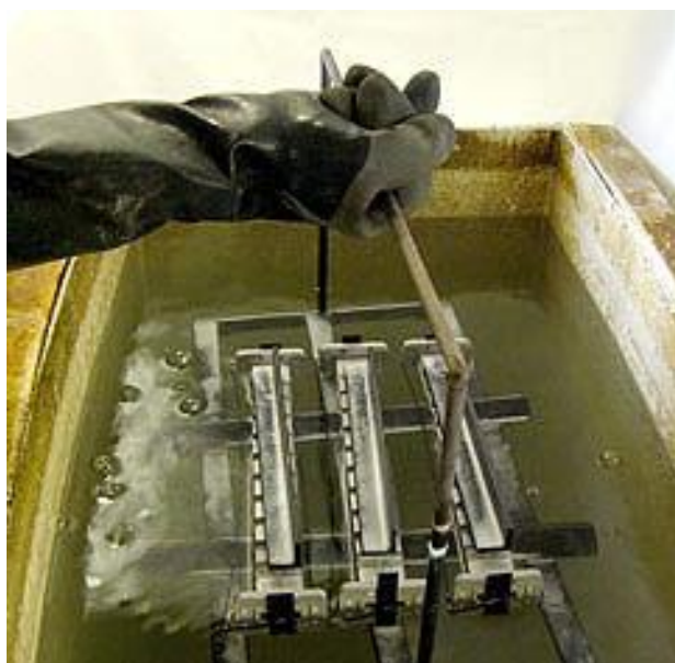
Slika 2.14. Lemljenje aluminijskih komponenti uranjanjem [15]
