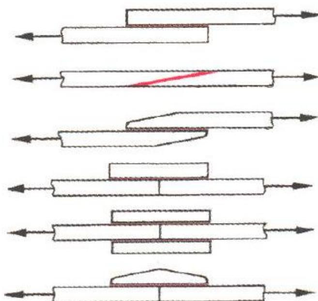
*Slika 4.8. Spojevi limova [6]*
