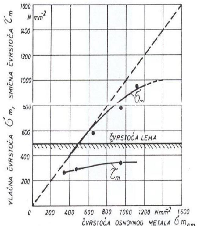
Slika 6.2. Vlačna i smična čvrstoća zaledljenog spoja u ovisnosti o vlačnoj čvrstoći osnovnog materijala [5]
