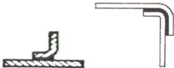
Slika 4.9. Spajanje limova "L" i "T" spojem[6]
