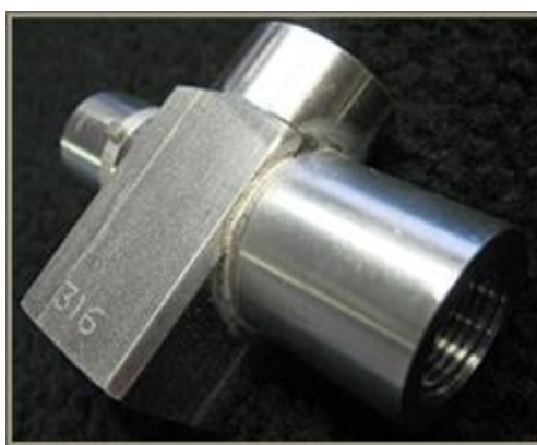
Slika 7.1. Lemljenje nehrđajućeg čelika [18]
