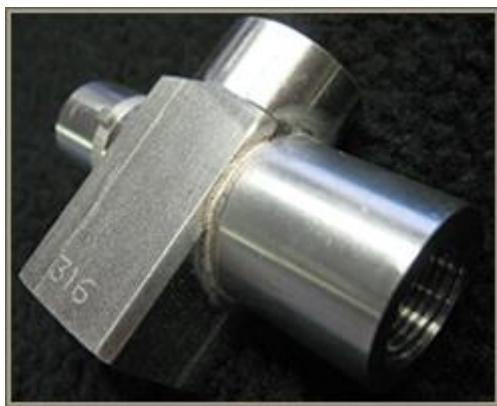
Slika 7.1. Lemljenje nehrđajućeg čelika [18]
