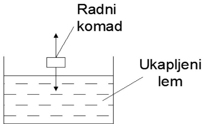
*Slika 2.13. Lemljenje uranjanjem [3]*
