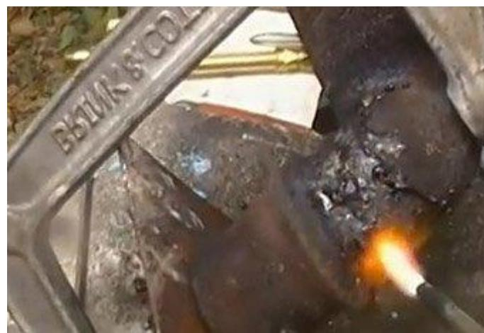
Slika 7.6. Lemljenje lijevanog željeza [21]
