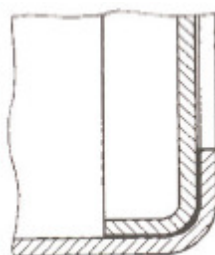
Slika 4.10. Ravno spajanje spremnika[6]
