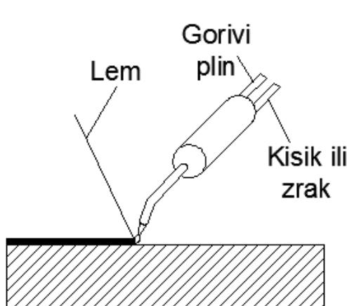
Slika 2.5. Shematski prikaz plinskog lemljenja [3]
