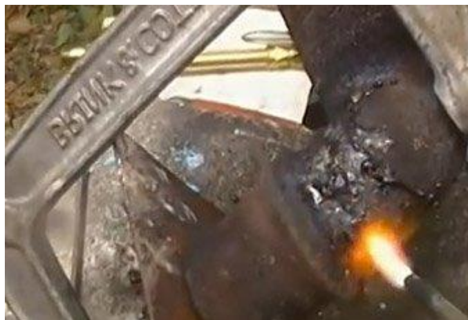
Slika 7.6. Lemljenje lijevanog željeza [21]
