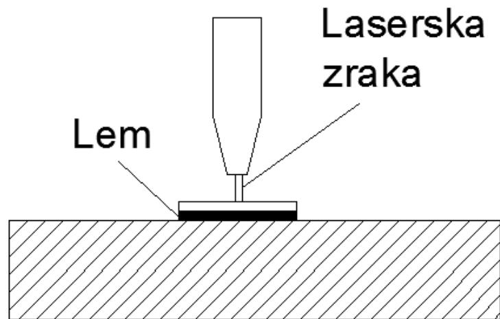
*Slika 2.21. Shematski prikaz lemljenja laserom [17 ]*
