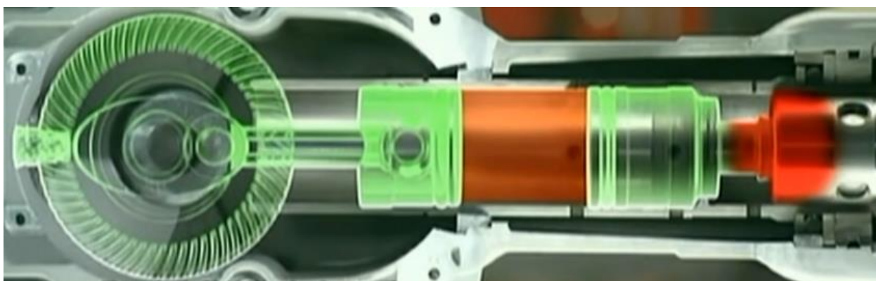
Slika 3. Prikaz kretanja klipa naprijed [33]
