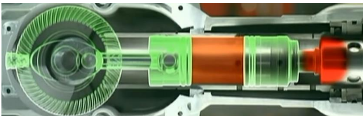
Slika 3. Prikaz kretanja klipa naprijed [33]
