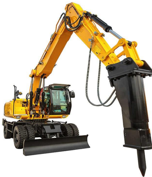
Slika 18. Hidraulični čekić pričvršćen na stroju [28]
