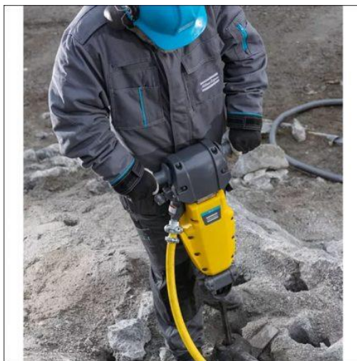
Slika 15. Prikaz korištenja pneumatskog čekića u praksi [25]
