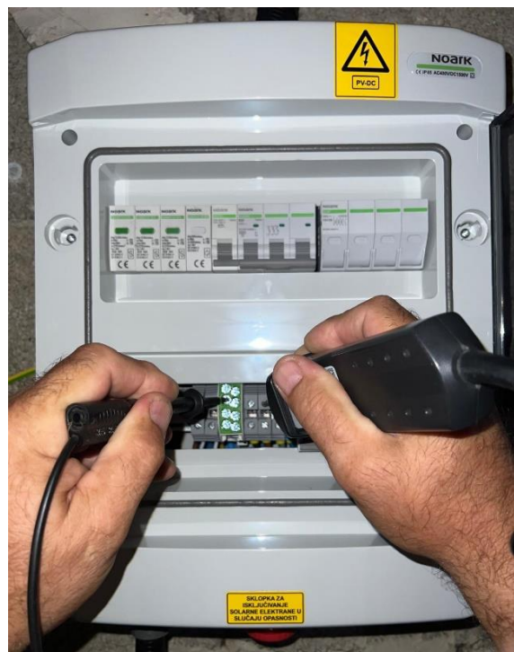
Slika 5.6. Ispitivanje otpora uzemljenja
