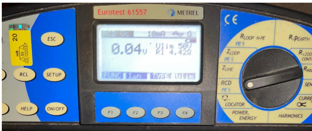
Slika 5.7. Rezultati dobiveni ispitivanjem otpora uzemljenja
