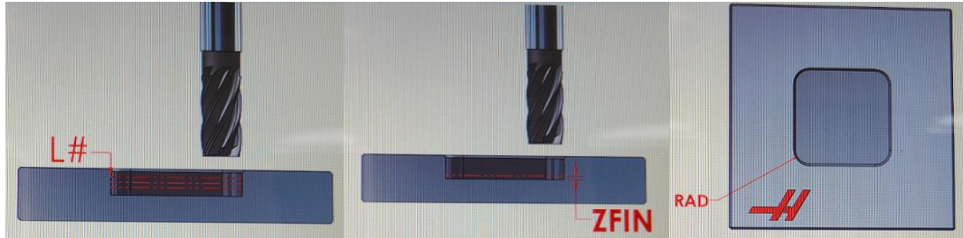
Slika 29. Grafički prikaz parametara „L“, „ZFIN“ i „RAD“
