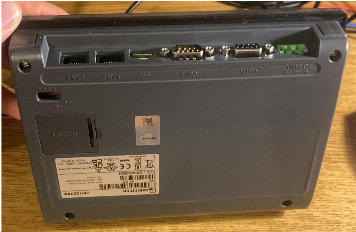
Slika 4.2 Komunikacijski priključci na HMI-u
