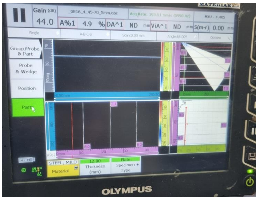
Slika 5.31 Odabir niskougličnog čelika i debljine 12 mm [28]
