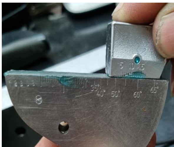
Slika 5.42 Kalibracija kuta sonde na kalibracijskom bloku V2 [28]
