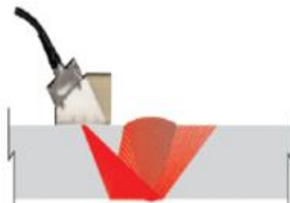
Slika 5.7 Ispitivanje višepretvorničkom sondom [20]
