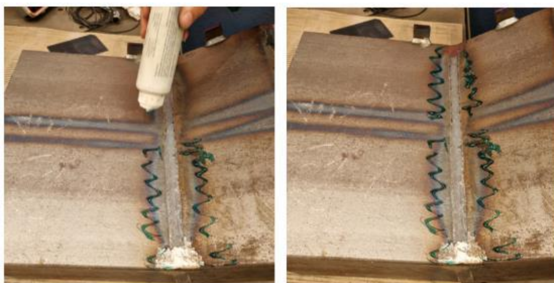
Slika 5.44 Nanošenje kontaktnog sredstva – gela oznake ZG-F na ispitnu površinu [28]
