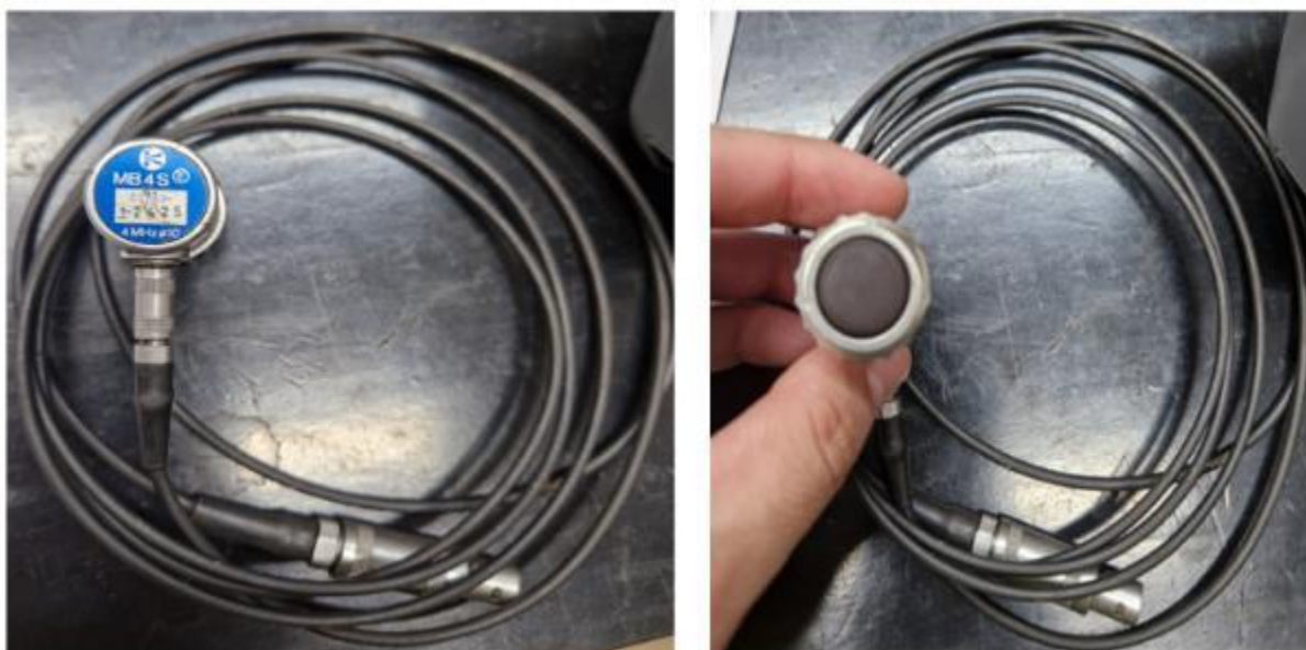
Slika 5.16 Ravna sonda MB4S [28]
