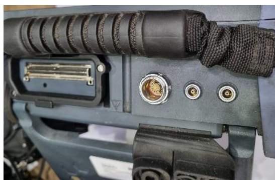
Slika 5.21 Ulaz za konektor na ultrazvučnom uređaju [28]
