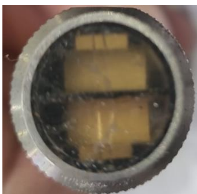
Slika 5.25 Kontaktna površina sonde [28]
