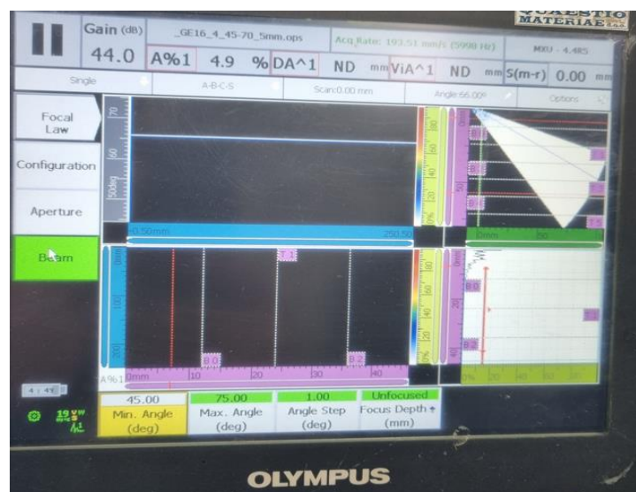
Slika 5.32 Postavljanje raspona kutova u materijalu od 45^\circ do 75^\circ i optimalnog koraka kuta od 1^\circ
