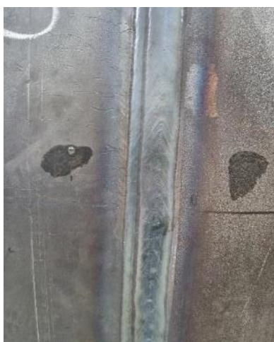
Slika 5.27 Nanošenje kontaktnog sredstva na ispitnu površinu [28]
