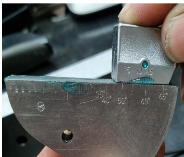
Slika 5.42 Kalibracija kuta sonde na kalibracijskom bloku V2 [28]
