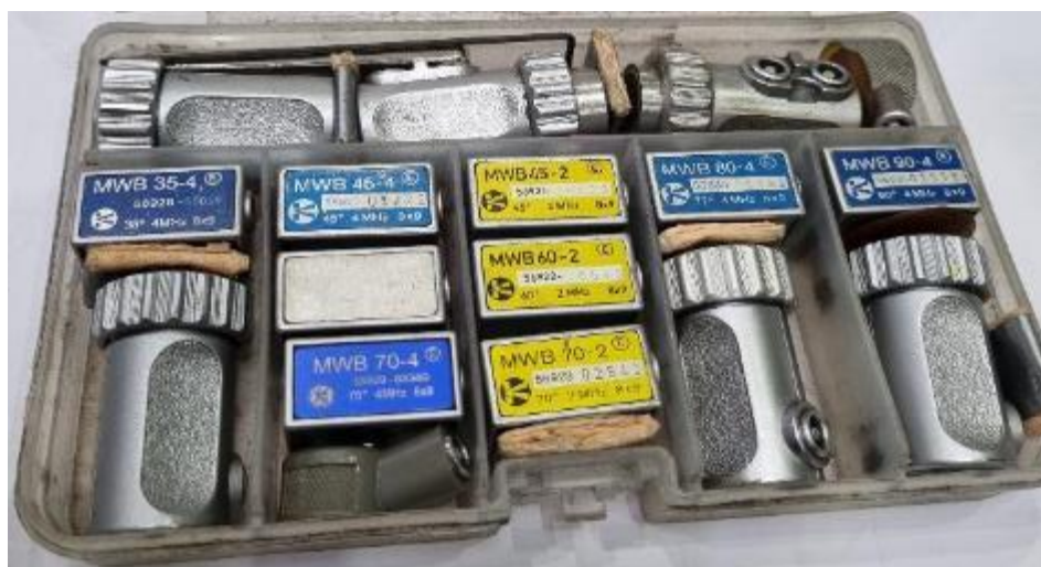
Slika 4.2 Razne vrste kutnih i ravnih sonda [28]
