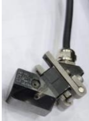
Slika 5.10 Višepretvornička sonda s klinom od 36° [28]
