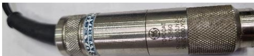
Slika 4.3 Ravna sonda sa frekvencijom 5 MHz [28]
