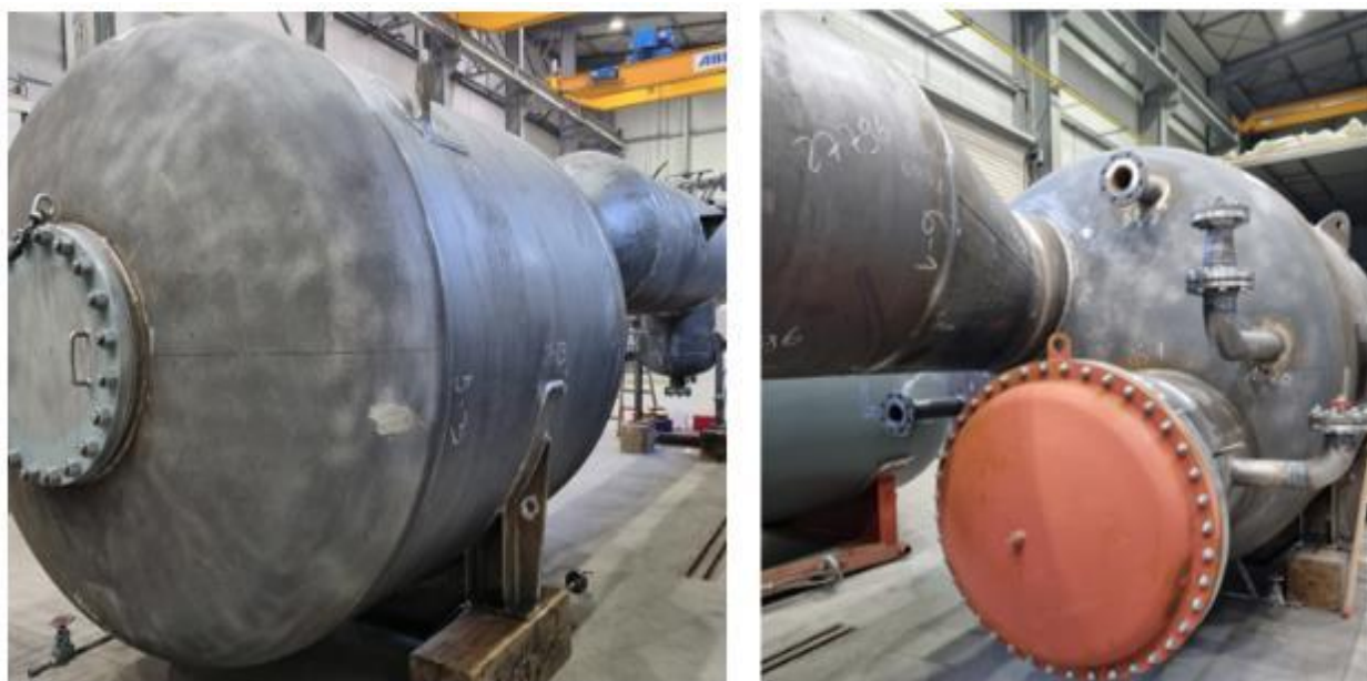
Slika 5.1 Regenerator - izmjenjivač topline [28]
