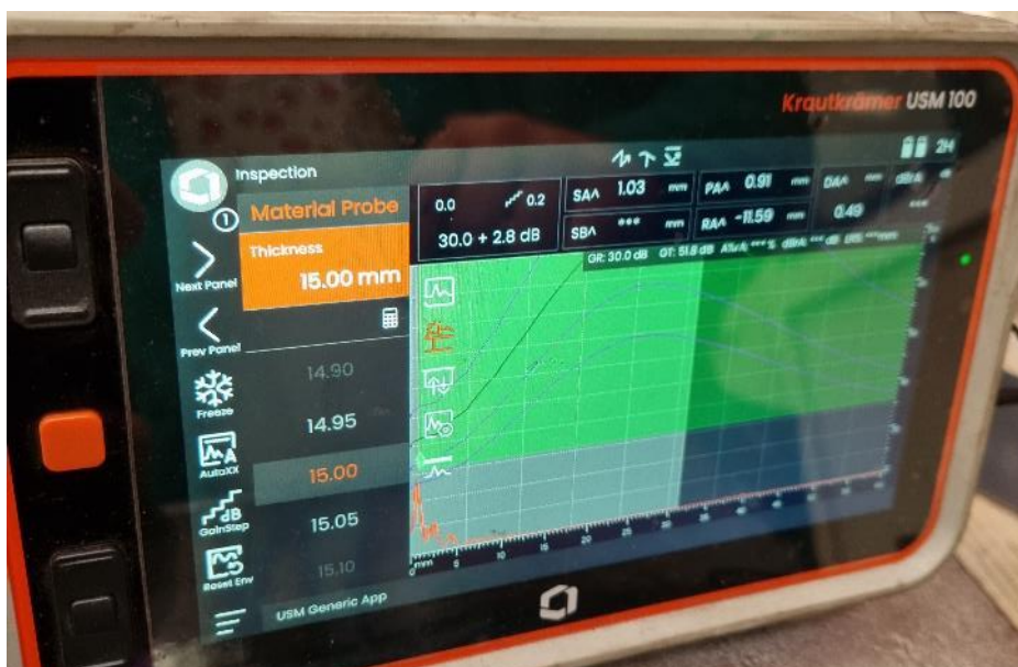
Slika 5.38 Unos debljine materijala ispitivanja u iznosu od 15 mm [28]
