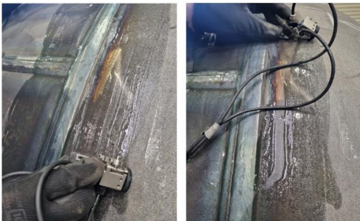
Slika 5.36 Vođenje sonde prilikom skeniranja zavara [28]
