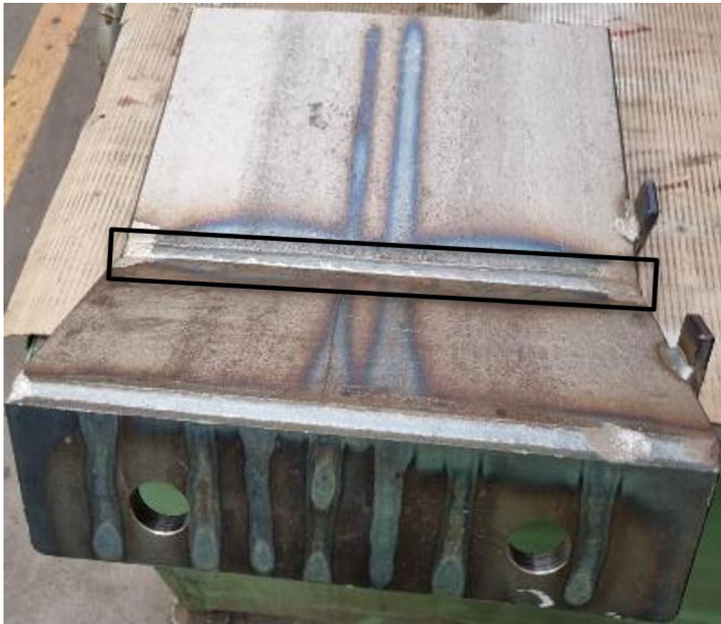
Slika 5.5 Sučeljeni X-zavar zavaren u sredini podsklopa transformatora [28]
