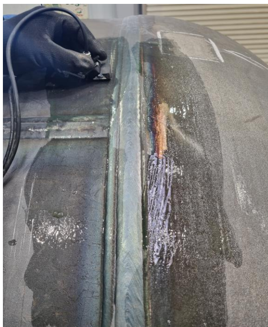
Slika 5.37 Postupak ispitivanja višepretvorničkom sondom [28]
