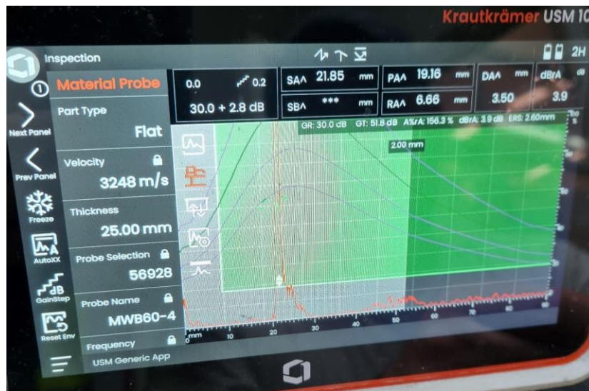
Slika 5.39 Unos baždarenog radijusa R25/V2 i prikaz najjačeg signala [28]
