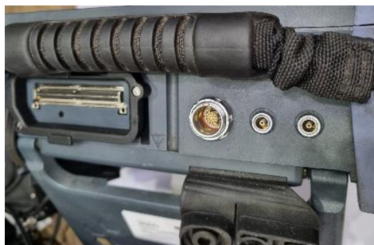
Slika 5.21 Ulaz za konektor na ultrazvučnom uređaju [28]
