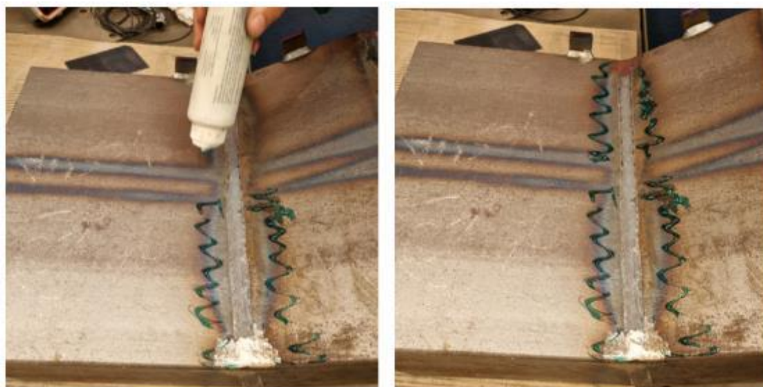
Slika 5.44 Nanošenje kontaktnog sredstva – gela oznake ZG-F na ispitnu površinu [28]
