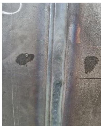
Slika 5.27 Nanošenje kontaktnog sredstva na ispitnu površinu [28]
