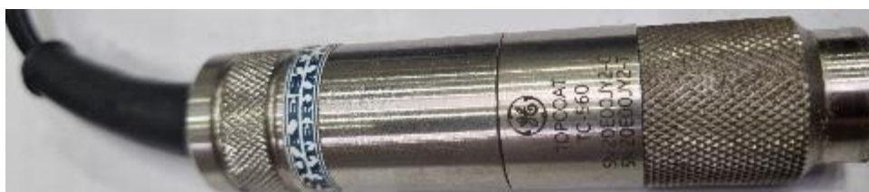
Slika 4.3 Ravna sonda sa frekvencijom 5 MHz [28]
