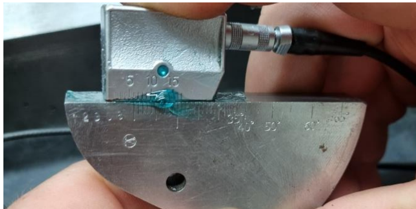
Slika 5.40 Određivanje izlazne točke kutne sonde na kalibracijskom bloku V2 [28]
