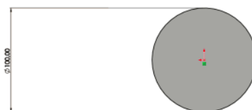
Slika 4.2.: Krug nacrtan alatom Kružnica i kotiran
