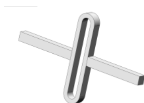
Slika 4.11.:Sklop jarma s vodilicama
