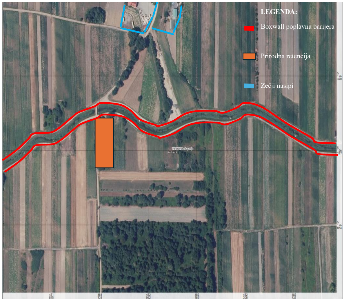
Slika 55 Prikaz položaja zečjih nasipa, boxwall pregrade i prirodne retencije [26]
