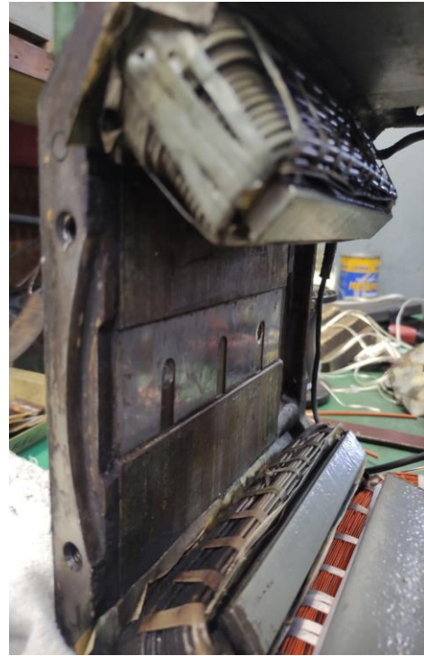
Slika 26. Pomoćni namot i utor uzbuđenog namota (slikano u Elki 26. 6. 2024.)
