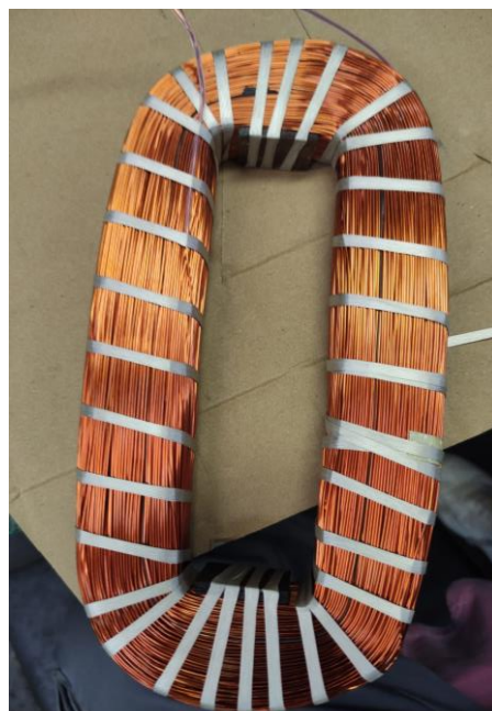
Slika 21. Uzbudni namot bandažiran trakom (slikano u Elki 26. 6. 2024.)
