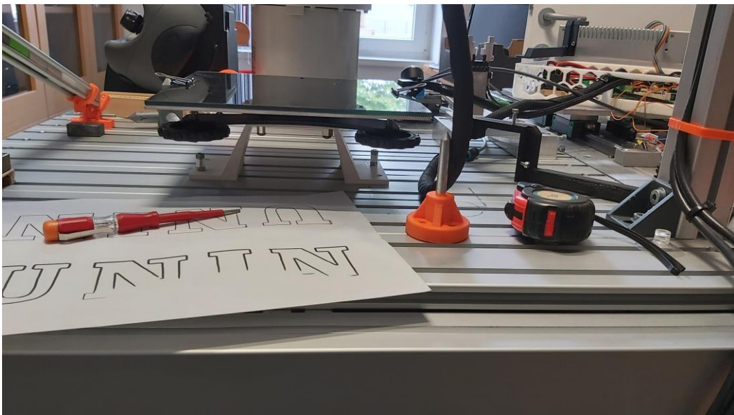
Slika 5.2 Montaža radne površine na stol
