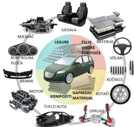
Slika 5. Primjer korištenja laganog materijala u konstrukciji automobila
