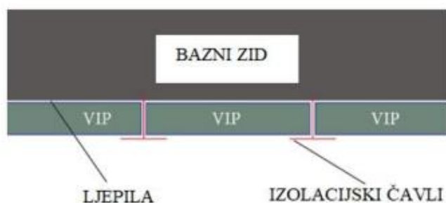
Slika 5.2.2. Shematski prikaz montiranja VIP ploča
