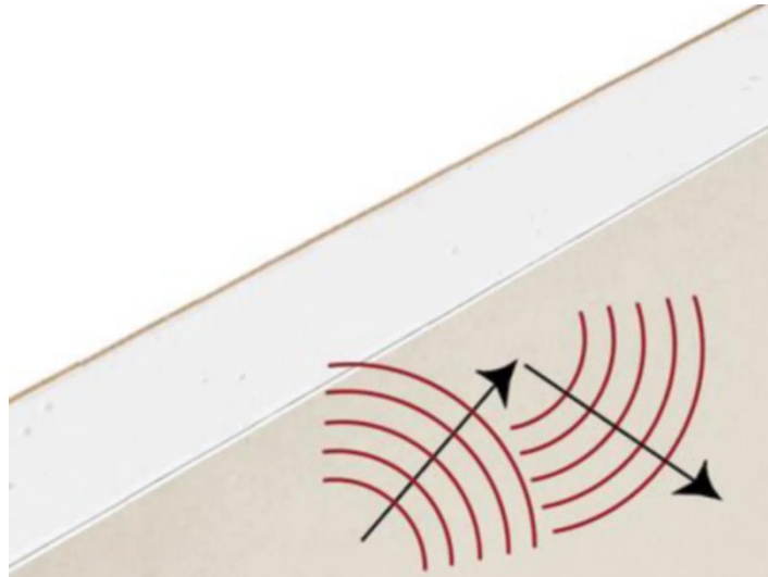
Slika 8.3.6. Prigušenje zvuka gips kartonskim pločama
