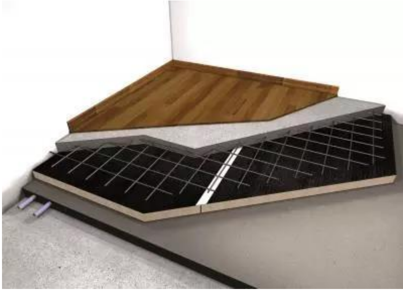
Slika 8.3.4. Plivajući pod s toplinsko zvučnom izolacijom
