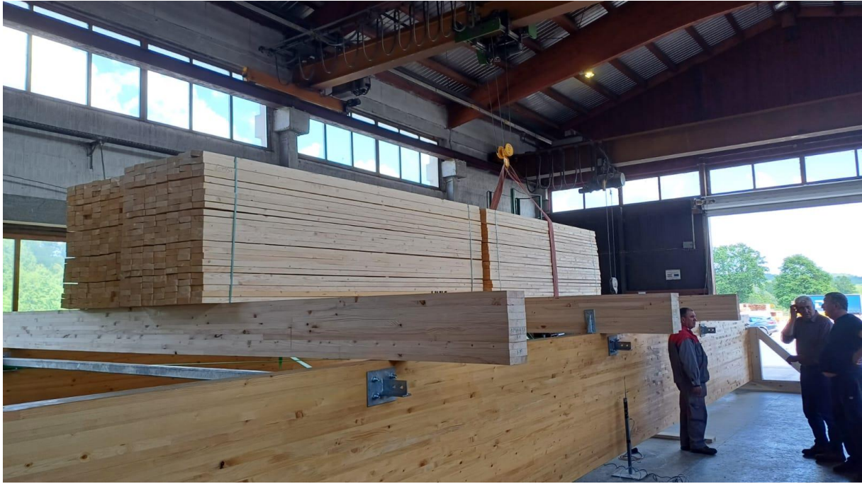
Slika 32. - Probno opterećenje LLD nosača
