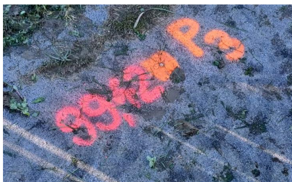
Slika 7. - Točka sa apsolutnom visinom
