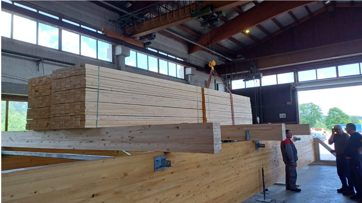
Slika 32. - Probno opterećenje LLD nosača
