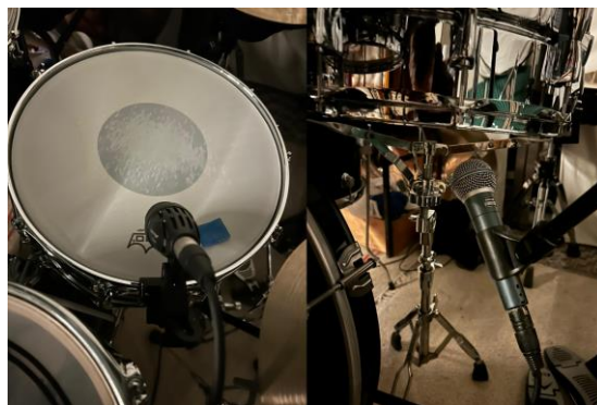
Slika 25 Postavljanje mikrofona za snare
