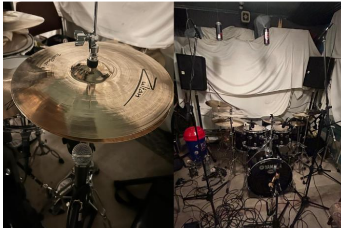
Slika 27 Postavljanje mikrofona za Hi-Hat i overhead
