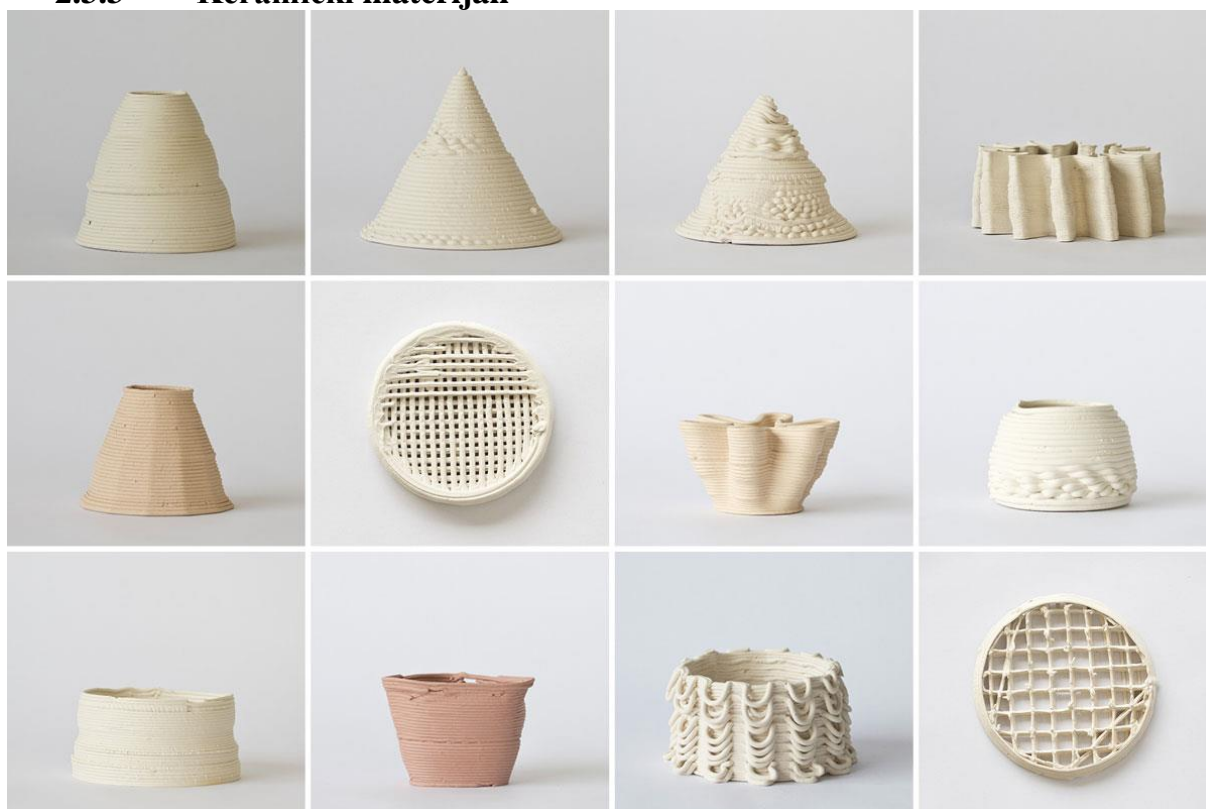
Slika 9: Keramika dobivena 3D ispisom
