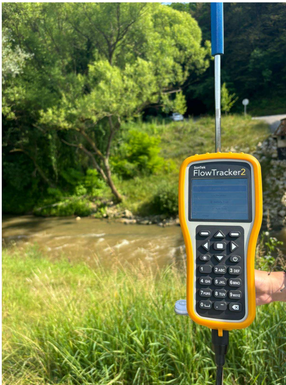
Slika 18. SonTek Flow Tracker 2 [19]
