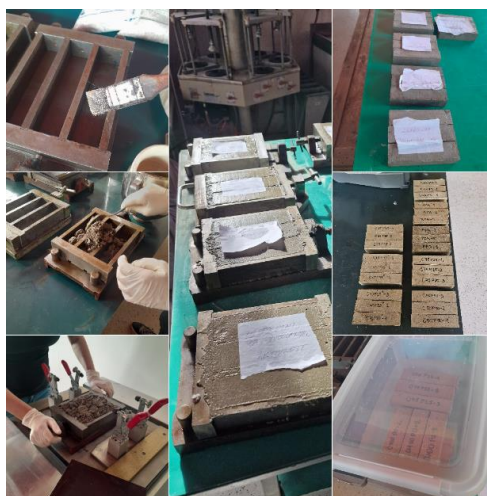
Slika 4.10 Ugrađivanje mješavine morta u kalupe i njegovanje očvrslu prizmica
