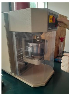
Slika 4.8 Miješalica za izradu mješavina morta
