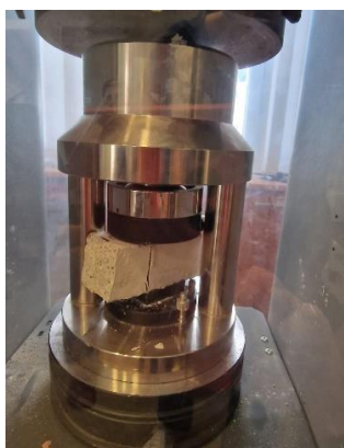
Slika 4.4 Ispitivanje tlačne čvrstoće prizmica sa kvarcnim pijeskom
