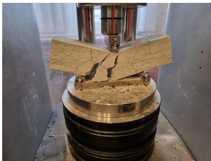
Slika 4.14 Slom prizme sa pepelom biomase prilikom određivanja vlačne čvrstoće
