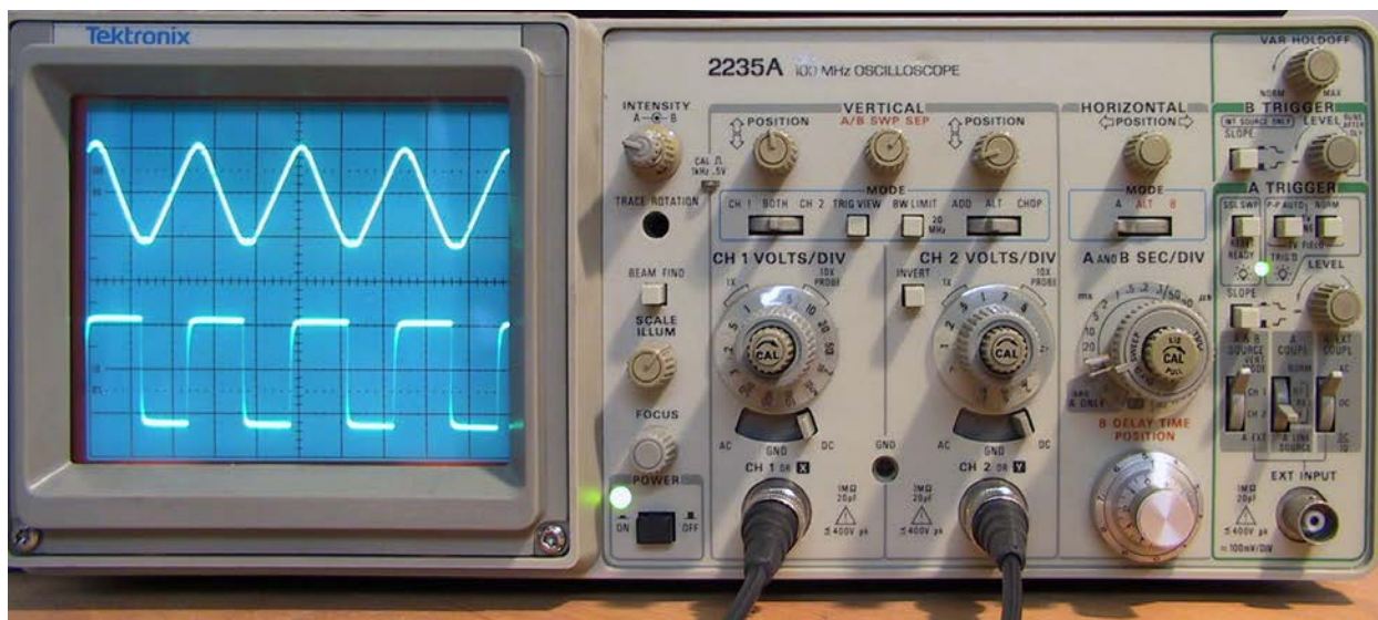
Slika 1: Osciloskop - elektronski mjerni uređaj koji omogućava promatranje međusobne ovisnosti dva signala na fluorescentnom zaslonu katodne cijevi, pristupljeno 8.9.2024.
