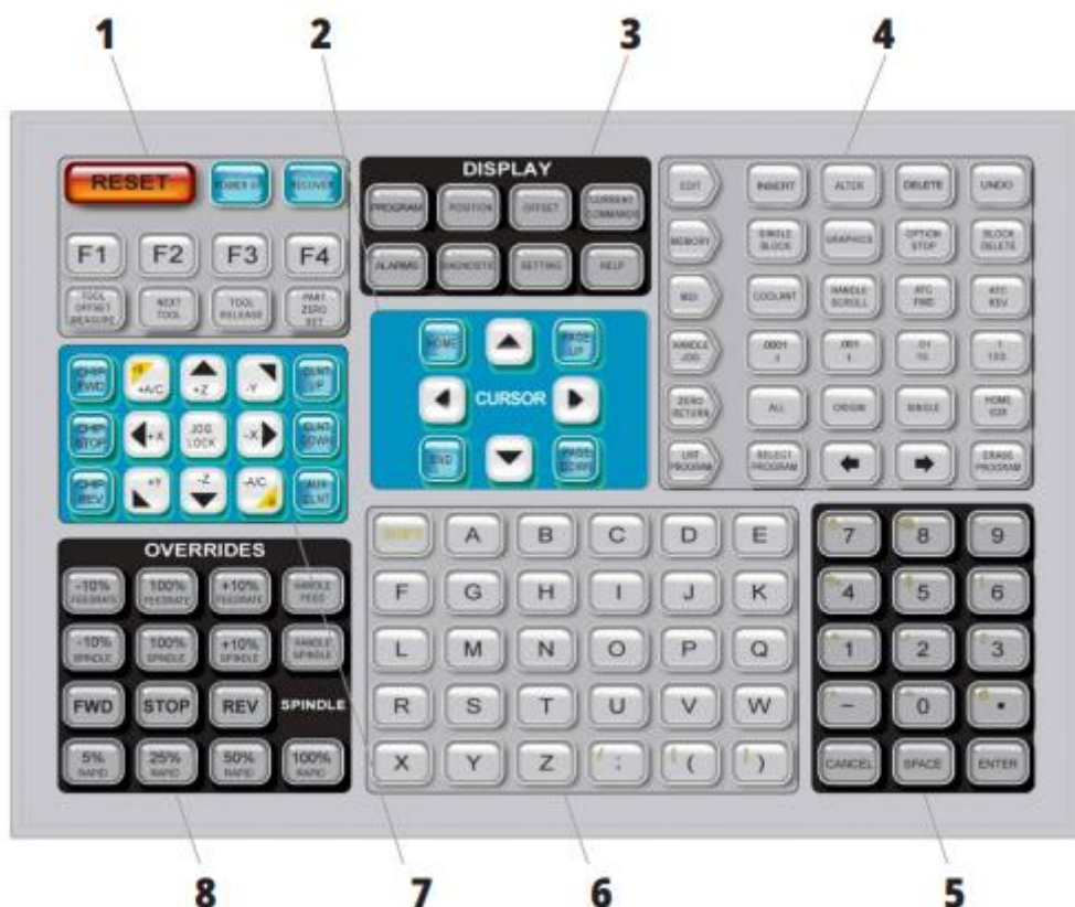
Slika 21. Tipkovnica upravljačke jedinice stroja [15]
