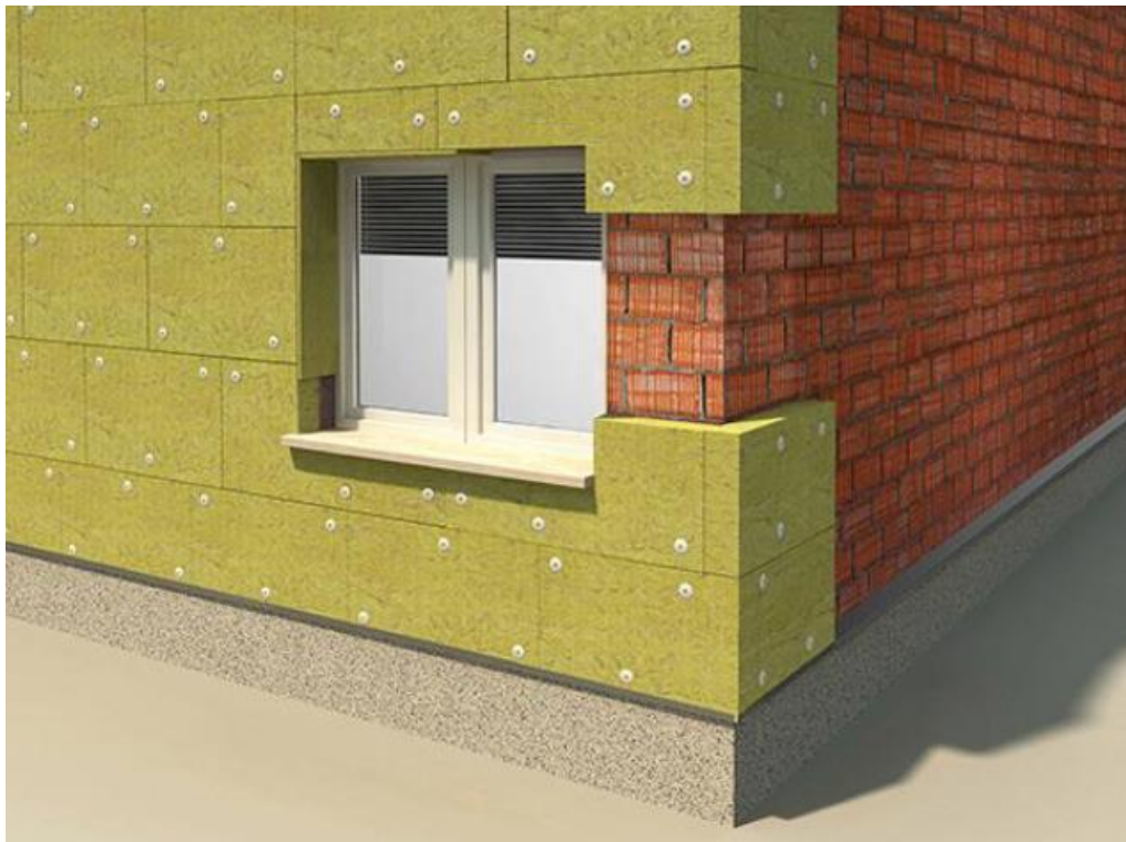
Slika 8. Izolacija vanjskih zidova mineralnom vunom [10]
