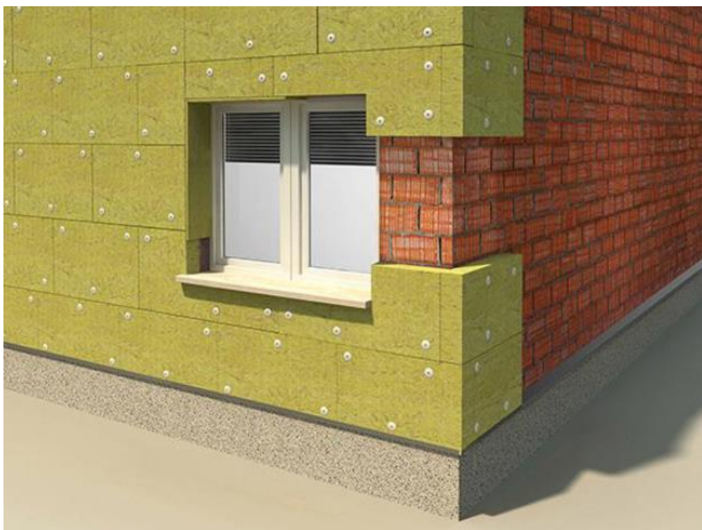
Slika 8. Izolacija vanjskih zidova mineralnom vunom [10]
