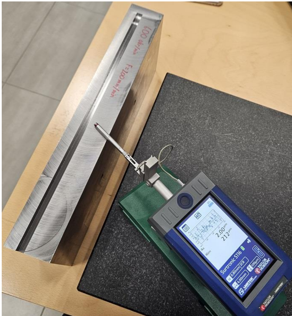
Slika 47: Mjerenje hrapavosti na bočnoj površini baze [osobne slike]
