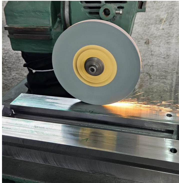
Slika 42: Brušenje baze škripca[osobne slike]
