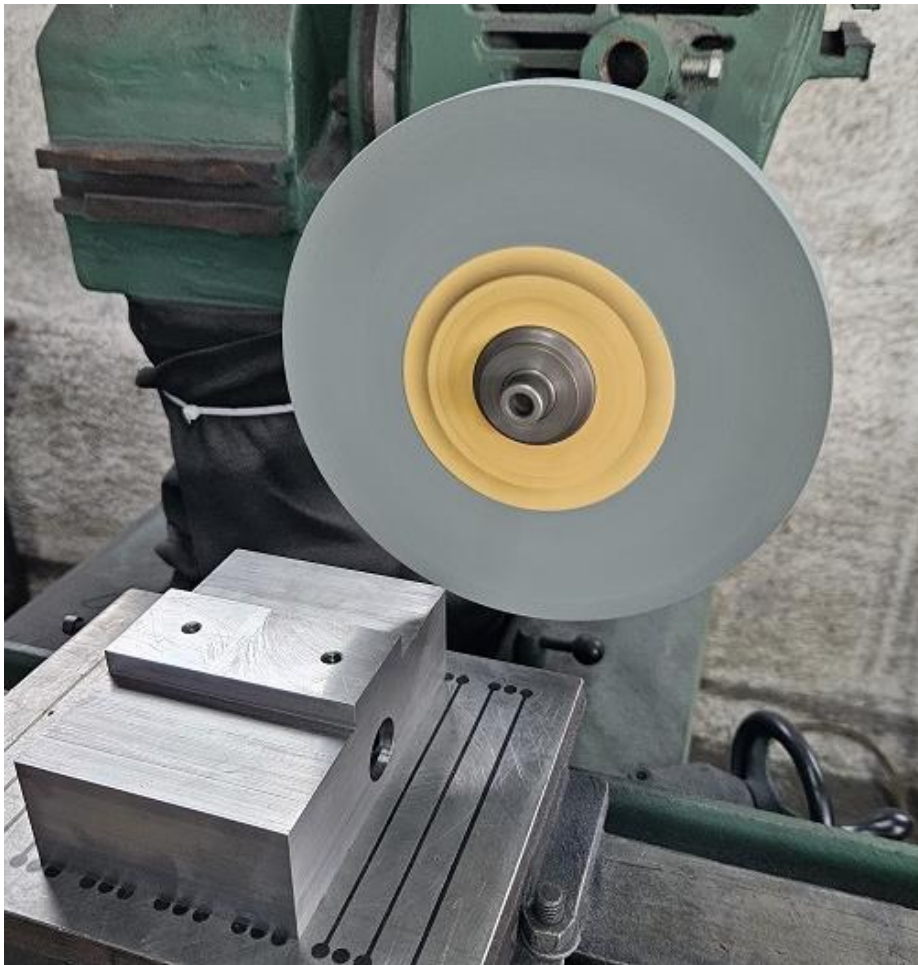
Slika 41: Brušenje donjeg dijela pomične čeljusti[osobne slike]
