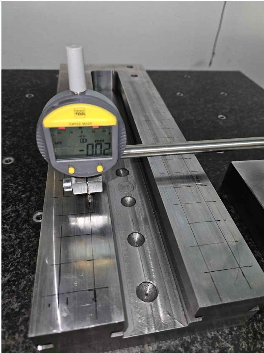
Slika 38: Mreža mjernih točaka [osobne slike]
