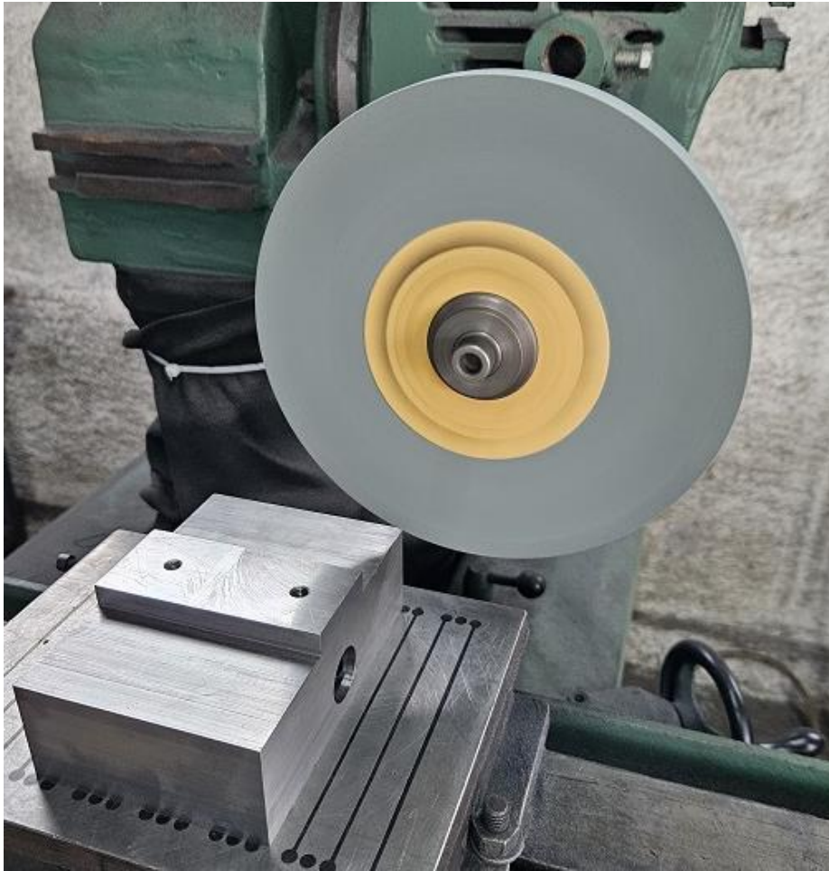
Slika 41: Brušenje donjeg dijela pomične čeljusti[osobne slike]
