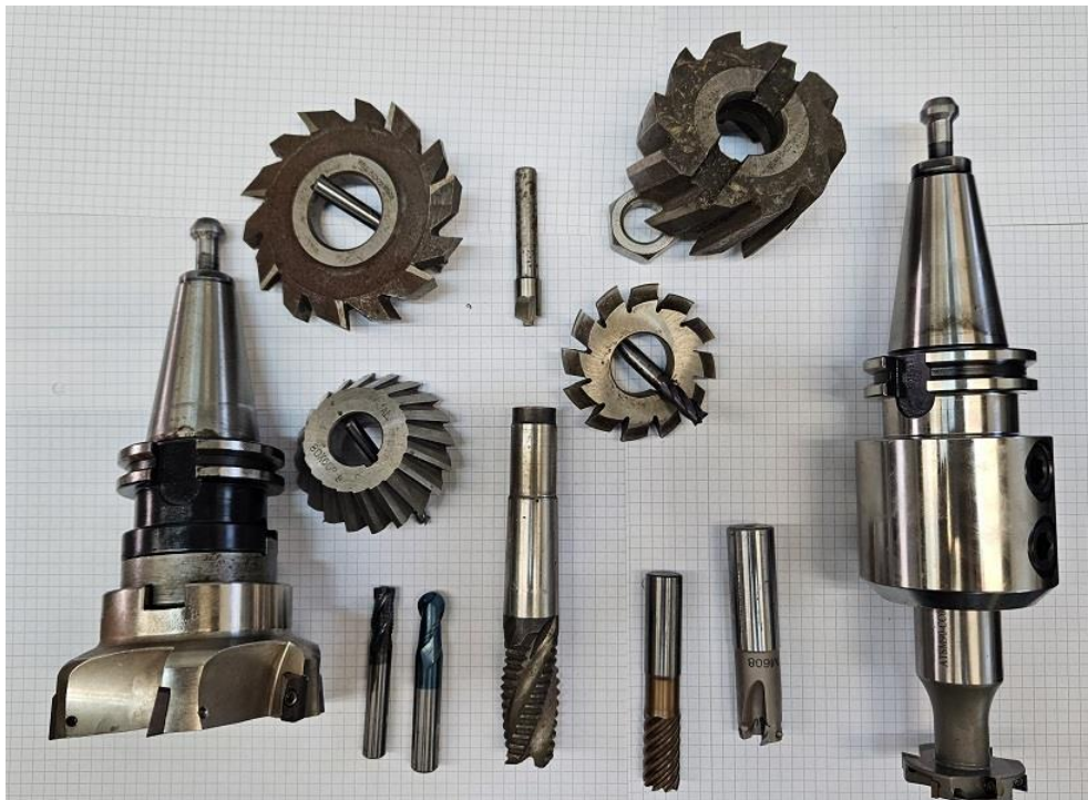
Slika 12. Izvedbe glodala [osobne slike]
