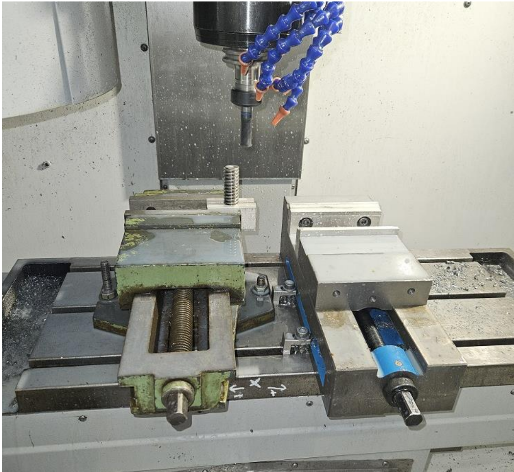
Slika 35: Glodanje šesterokuta na trapeznom navoju[osobne slike]
