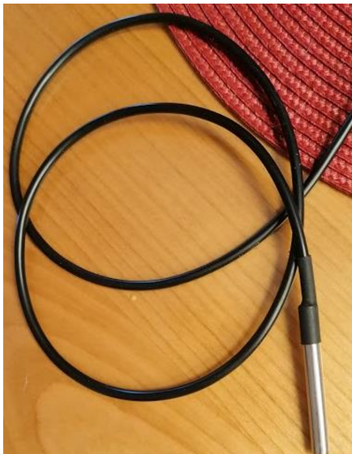
Slika 2.4, Temperaturni senzor i njegove žice
