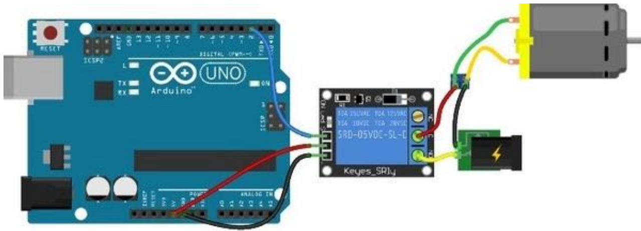
Slika 3.2, Shema spajanja DC motora preko releja [4]
