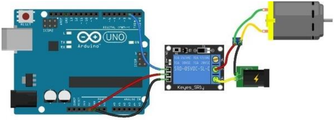
Slika 3.2, Shema spajanja DC motora preko releja [4]
