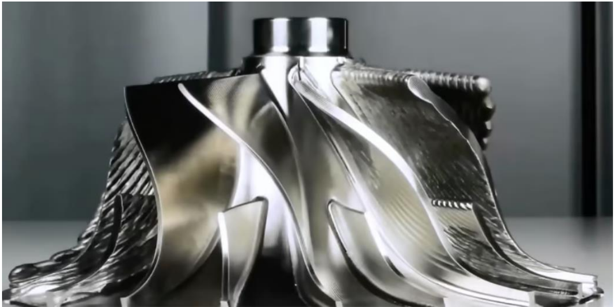
Slika 30 Turbina brodskog dizel motora izrađena WAAM-om [32]
