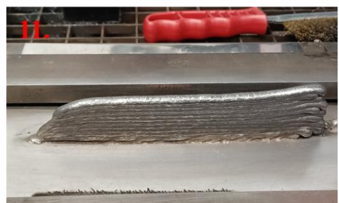
Slika 44 Izrada uzorka 1 sloj po sloj
