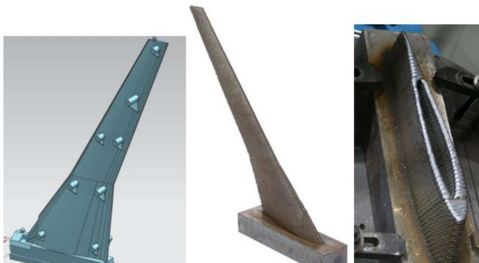
Slika 18 Izrada čeličnih proizvoda WAAM postupkom [1]
