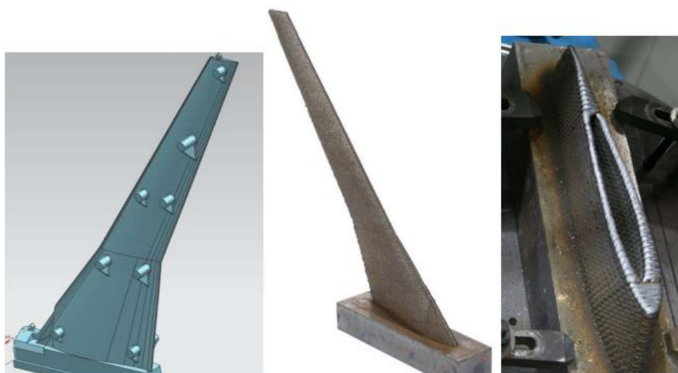
Slika 18 Izrada čeličnih proizvoda WAAM postupkom [1]
