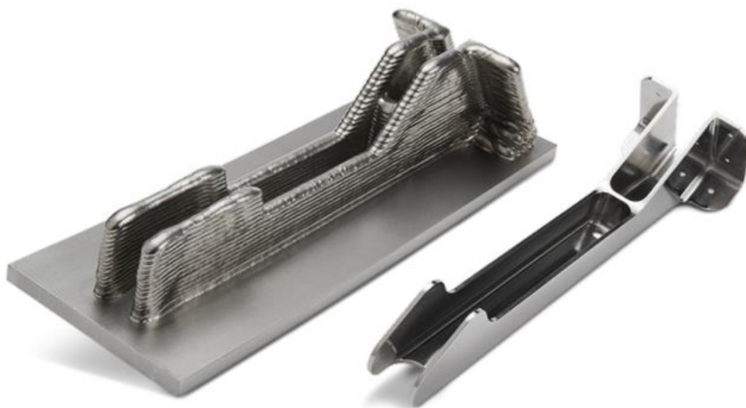
Slika 27 Komponenta zrakoplova 787 Dreamliner izrađena WAAM postupkom [29]
