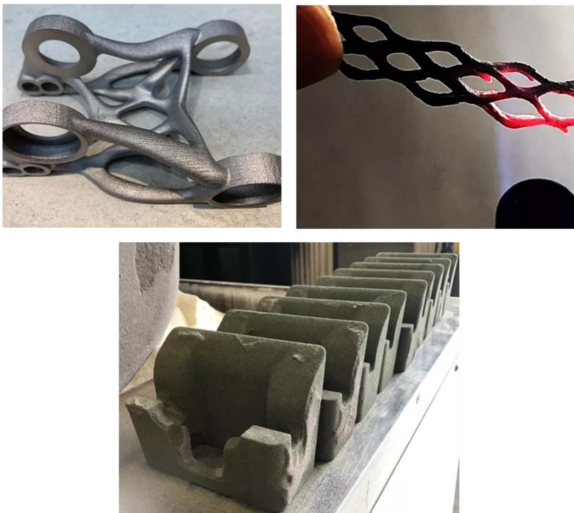
Slika 2 Predmeti od različitih materijala izrađeni aditivnim postupcima [4]
