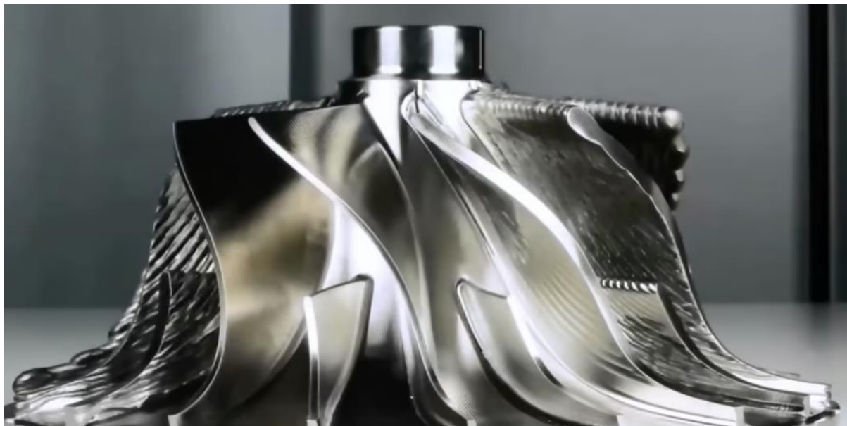
Slika 30 Turbina brodskog dizel motora izrađena WAAM-om [32]
