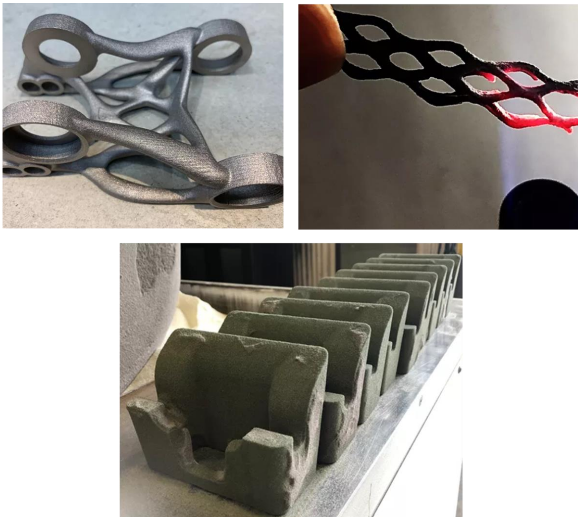
Slika 2 Predmeti od različitih materijala izrađeni aditivnim postupcima [4]
