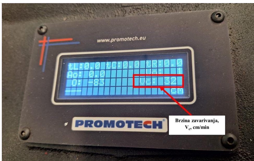
Slika 42 Namještanje brzine zavarivanja
