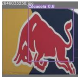
Slika 4.5. Neuspješna detekcija logotipa RedBull (pogrešna klasifikacija Coca Cola, preciznost 0,6)
